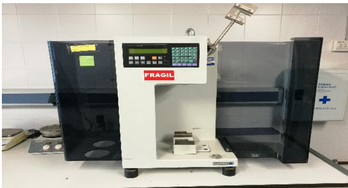
Figura 47: Equip d'assaig d'impacte per el mètode Charpy
