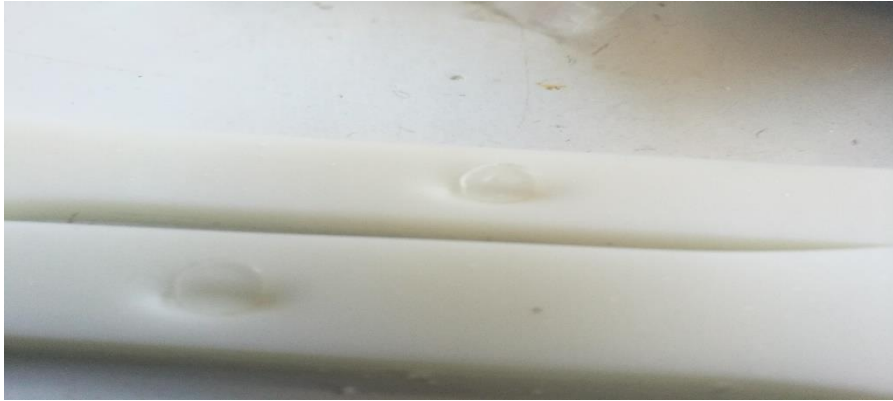
Figura 56: Proveta amb "sink marks"
