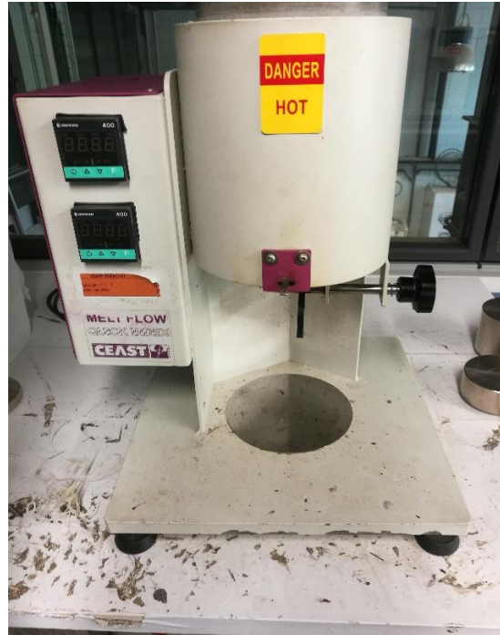
Figura 48: Equip de Melt Flow Index
