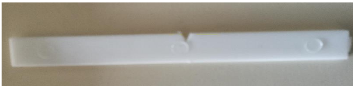
Figura 59: Provetes d'assaig d'impacte amb entalla
