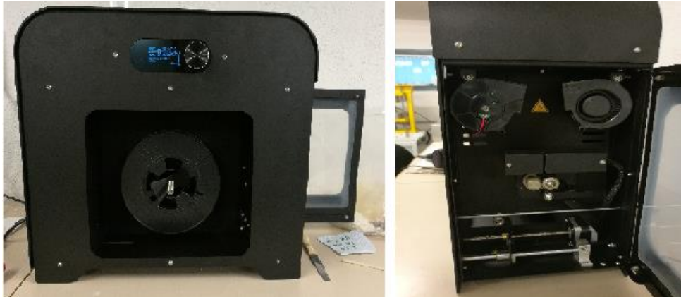
Figura 52: Extrusora de filament de l'EPS (visió frontal(1) i de perfil(2))
