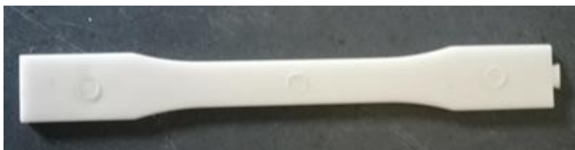
Figura 57: Provena d'assaig a tracció
