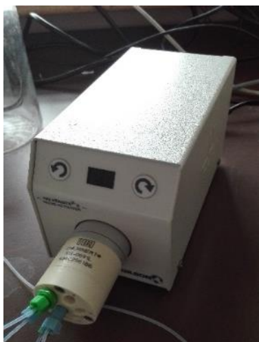
Figura 11: Vàlvula de 6 vies i actuador marca GILSON model Valvemate II
