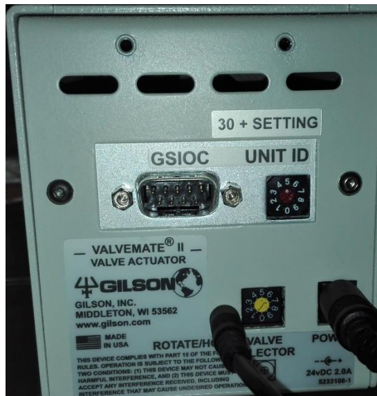
Figura 32: Connexions de la vàlvula GILSON Valvemate II
