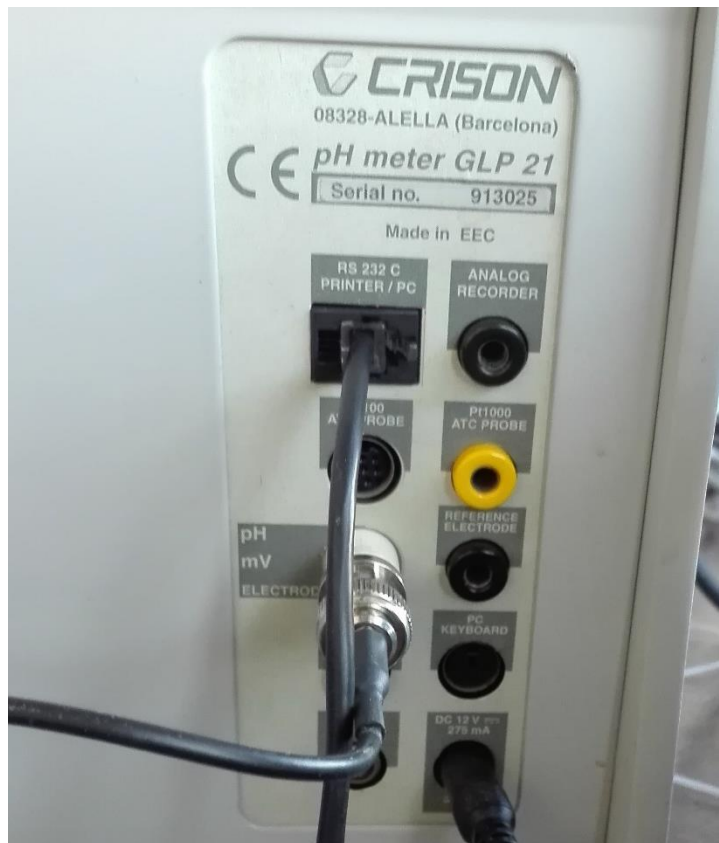
Figura 31: Connexions d'entrada i sortida del potenciòmetre CRISON GLP21
