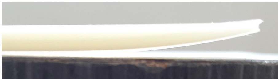
Figura 18: Exemple de "warping"
