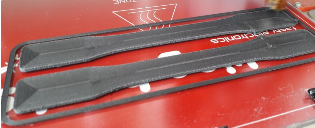
Figura 24: Direcció d'impressió de les provetes tipus II.
