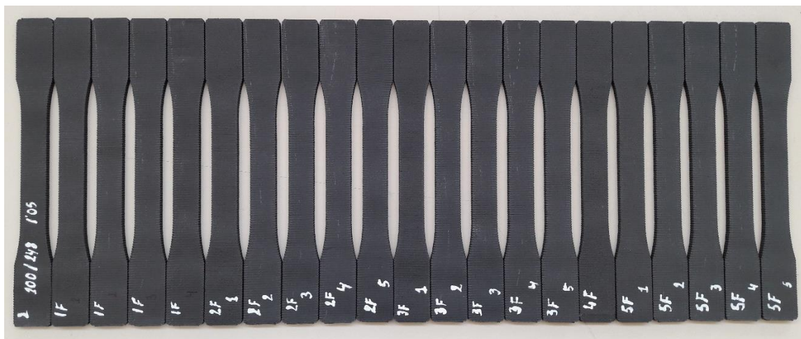
Figura 23: Resultats d'impressió de les provetes tipus I.
