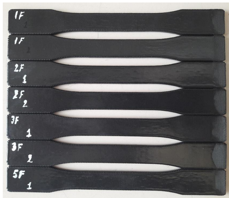
Figura 31: Provetes tipus I tractades durant 30 min.
