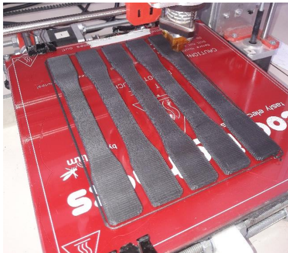
Figura 22: Direcció d'impressió de les provetes tipus I.
