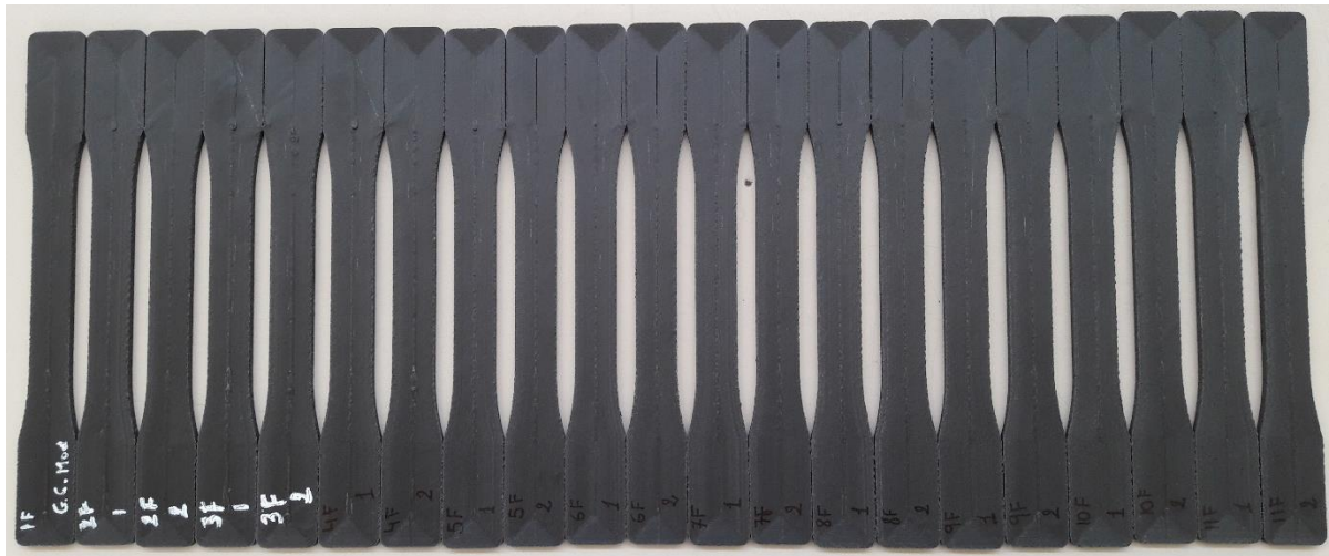
Figura 25: Resultats d'impressió de les provetes tipus II.
