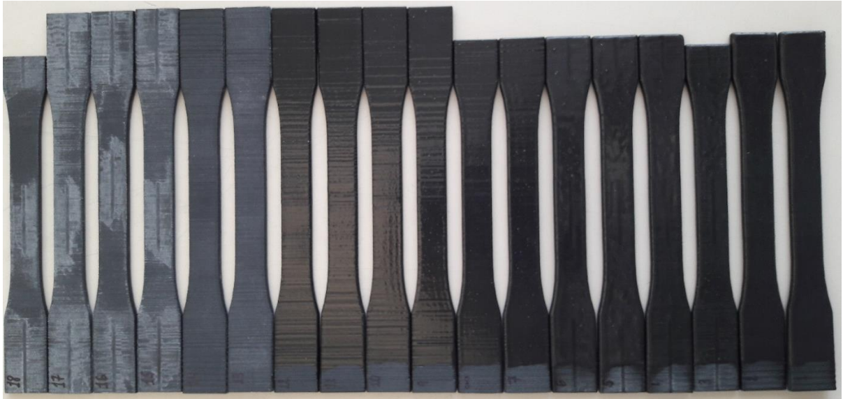
Figura 29: Resultats d'impressió de les provetes tipus III.
