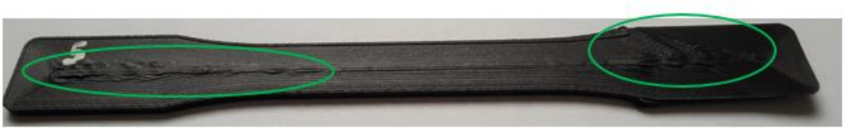
Figura 19: Exemple d'excés de material
