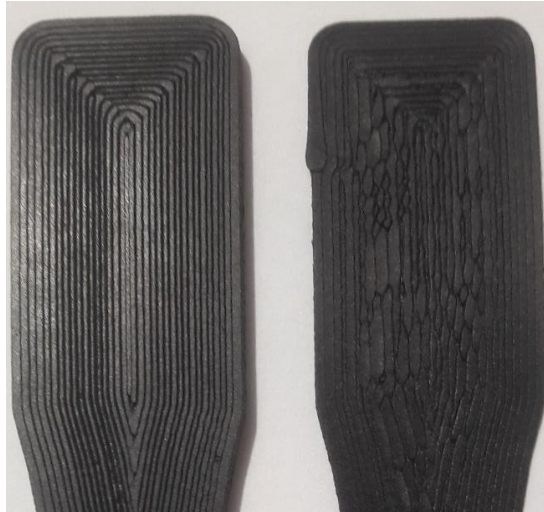
Figura 21: Llit ben calibrat (Esquerra), Llit mal calibrat (Dreta)
