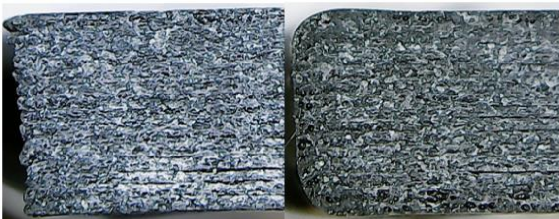
Figura 32: Comparació d'una proveta tipus I sense tractar (esquerra) i una tractada (dreta).
