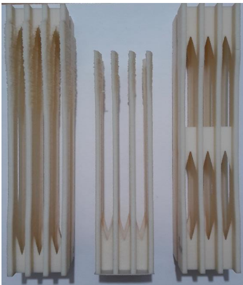
Figura 27: Evolució del model de provetes tipus III. Figura 28: Exemple de falta de material
