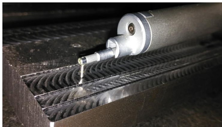
Figura 3.16. Rugosímetre avaluant la rugositat superficial
