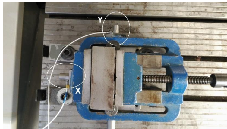
Figura 2.15. Disposició dels acceleròmetres
