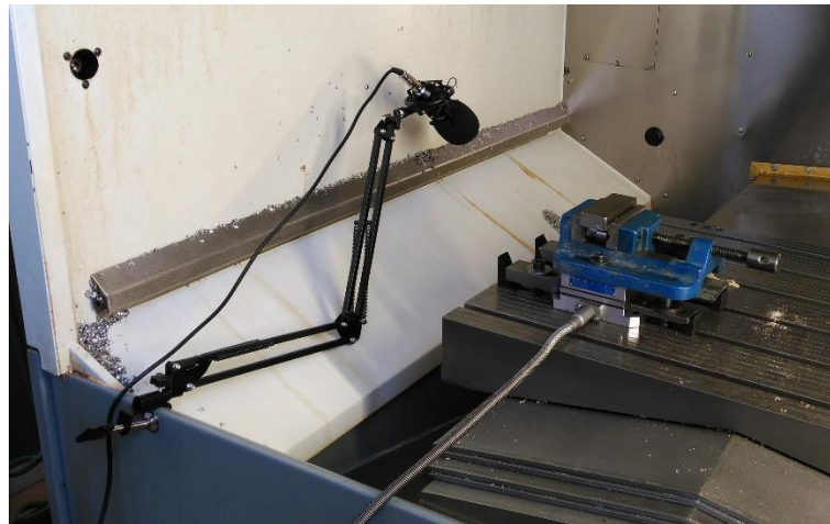
Figura 2.18. Micròfon instal·lat al centre de mecanitzat
