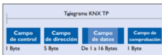
Figura 5.- Estructura telegrama KNX TP
