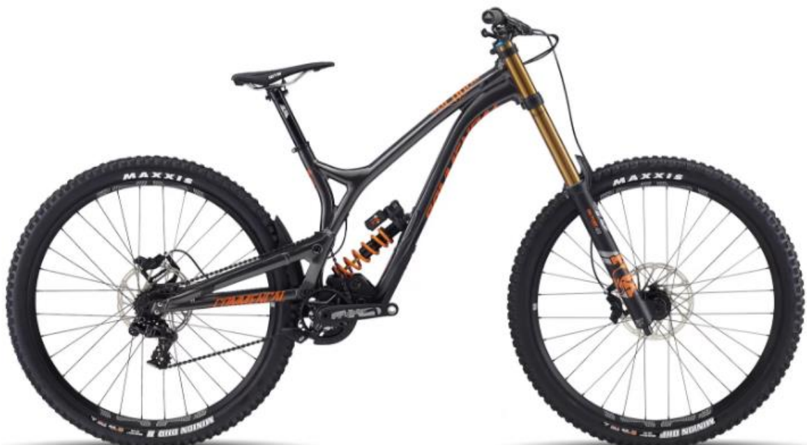
Figura2: un model de descens amb un sistema de suspensió amb el pivot més elevat
