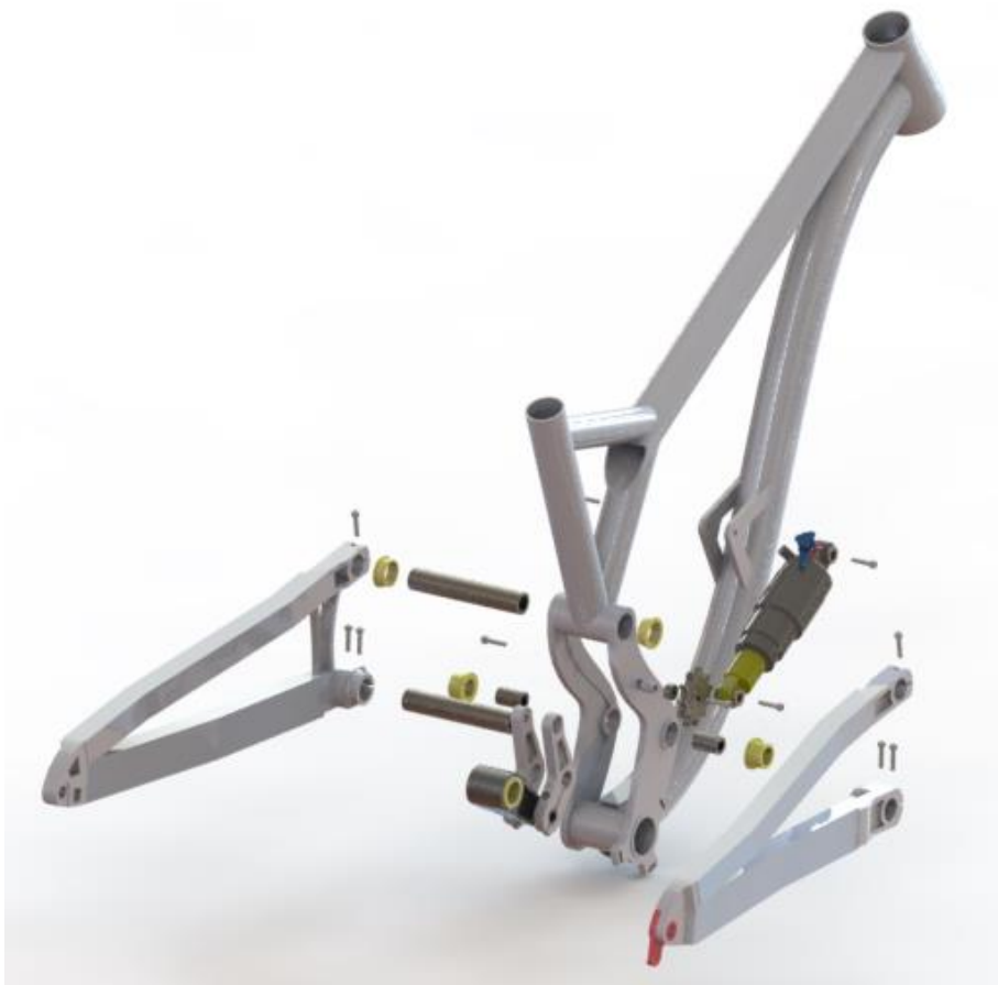
Figura9: renders del quadre, vista completa i explosionada
