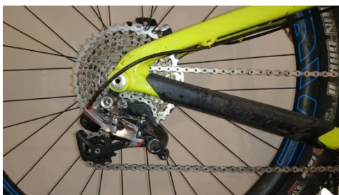
Figura D.2.5: cadena poc tensada engranada en un pinyó petit
