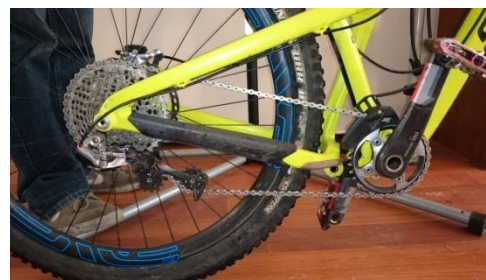
Figura D.2.6: cadena molt tensada en pinyó gran
