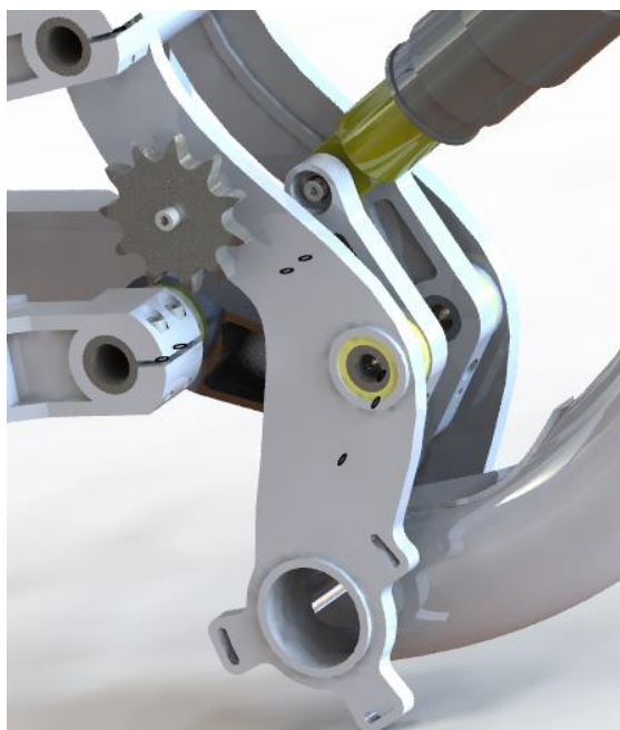
Figura48: detall de les bieletes amb el triangle principal
