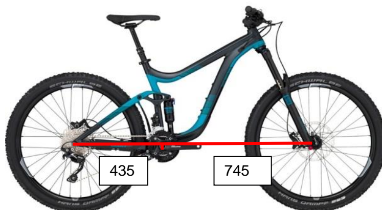
Figura22: Giant Rgein i la seva longitud d'eixos per components
