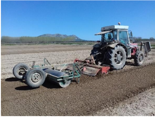
Figura 26. Preparació del sòl amb roleu i fresadora. Font: IRTA Mas Badia
