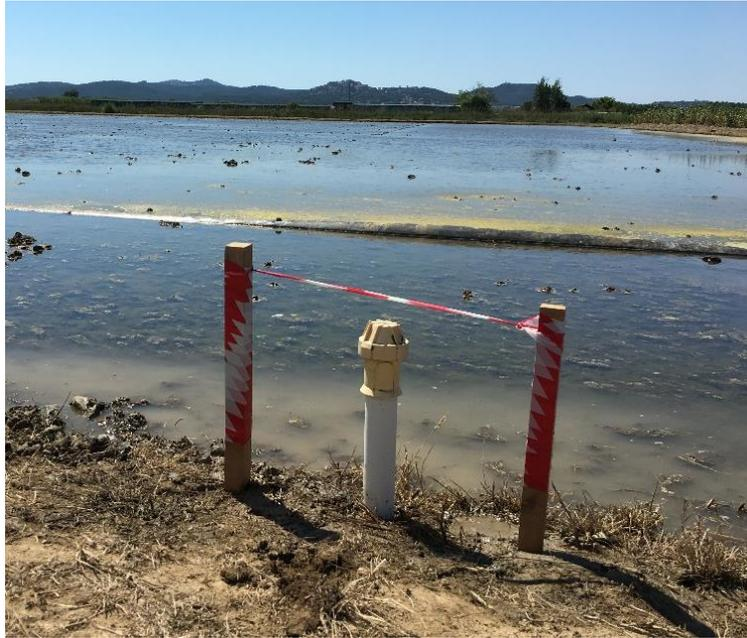
Figura 32. Piezómetro instalado en la parcela RIC.
