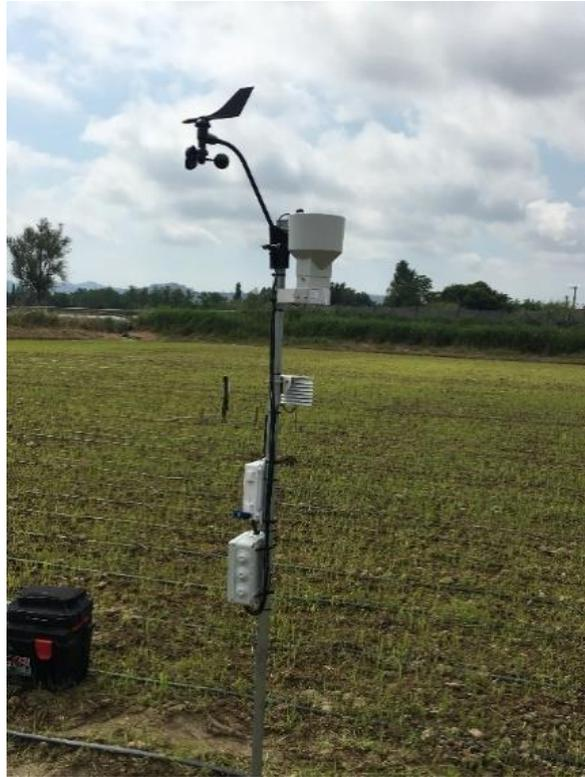
**Figura 30. Estación agroclimática instalada en la parcela RG.**
