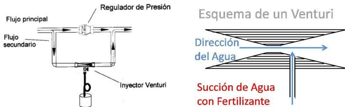
Figura 28. Esquema de su funcionamiento de fertirrigación por efecto Venturi (izquierda, (Martínez, 1998)) y detalle del esquema de un Venturi (derecha, (Hernández, 2018)).
