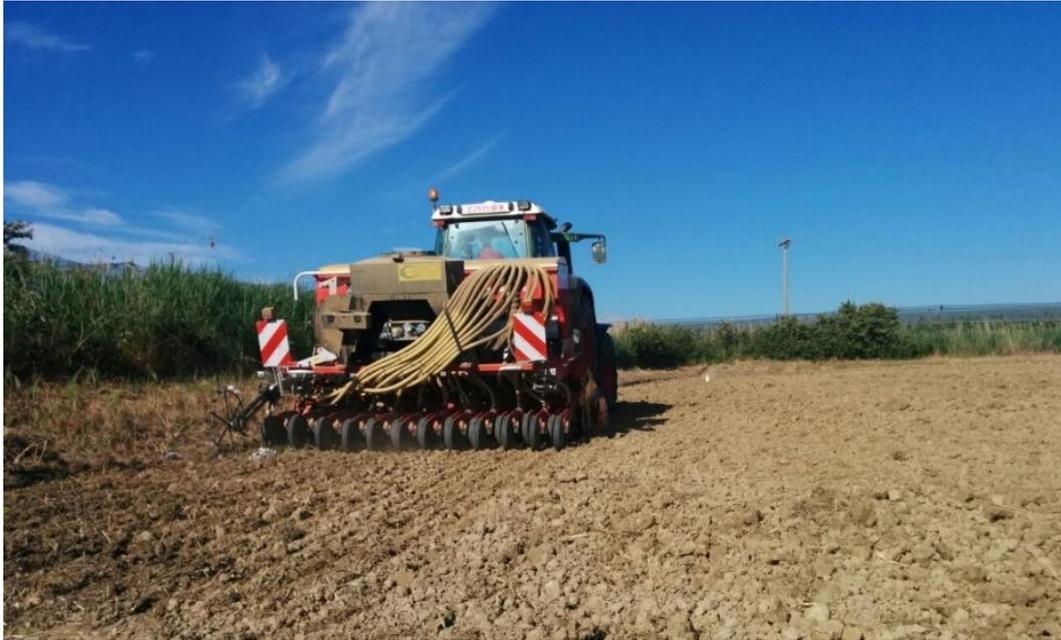
**Figura 25. Sembradora de cereales a línea sembrando el arroz en la parcela RG.**
