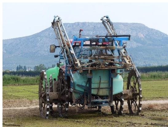
**Figura 29. Tractor con ruedas metálicas utilizado en la realización de los tratamientos fitosanitarios. Fotografía izquierda: parte anterior y fotografía derecha: parte posterior.**
