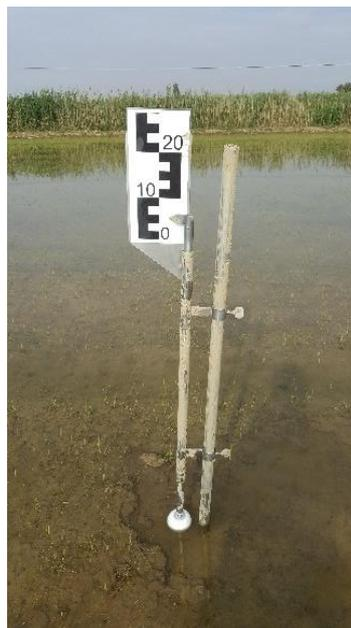
**Figura 26. Equipo para la medición de la lámina de agua en la parcela RIC.**
