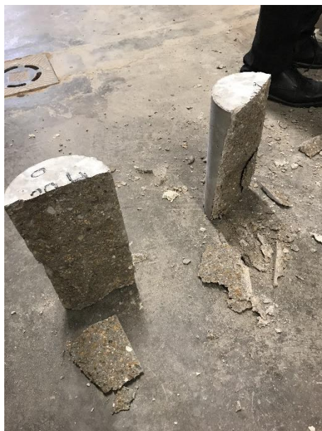
Imatge 90. Trencament correcte de les provetes a tracció. Font: pròpia
