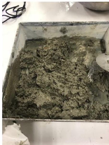
Imatge 44. Mostra del morter autoanivellant amb una relació AC 1/2 i un 5% de fibra i fluidificant. Font: pròpia
