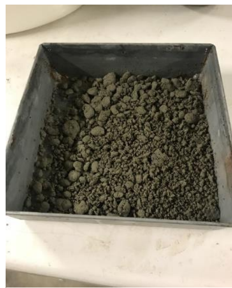
Imatge 40. Mostra del morter autoanivellant amb una relació AC 1/3 i un 10% de fibra.
