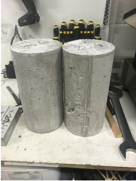
Imatge 85. Provetes cilíndriques per l'assaig brasiler de tracció indirecte. Font: pròpia
