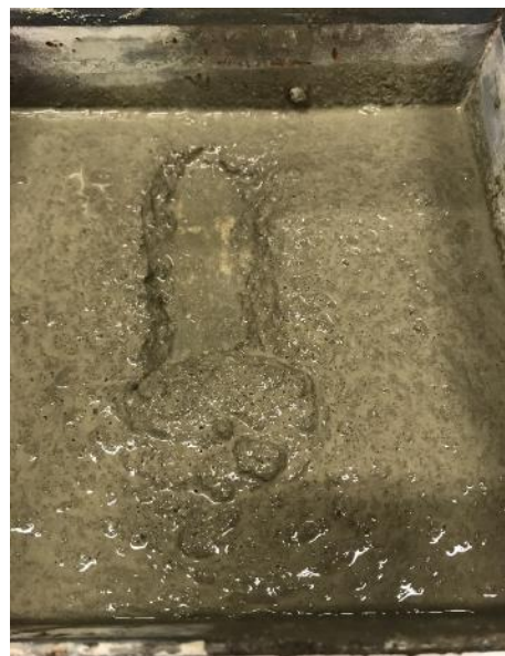
Imatge 46. Mostra del morter autoanivellant amb una relació AC 1/2 i un 3% de fibra. Font: pròpia
