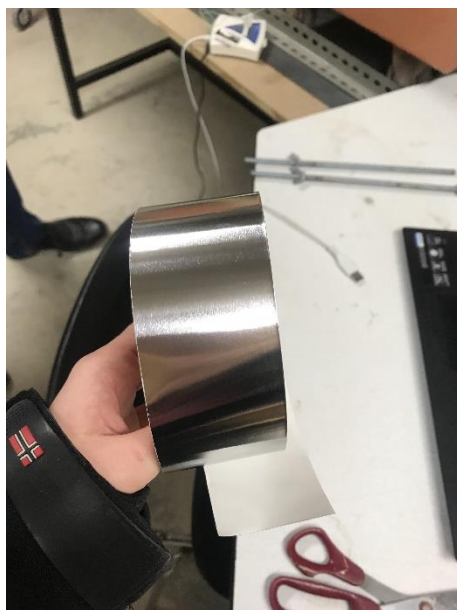
Imatge 40. Cinta aïllant per subjectar el termopad. Font: pròpia
