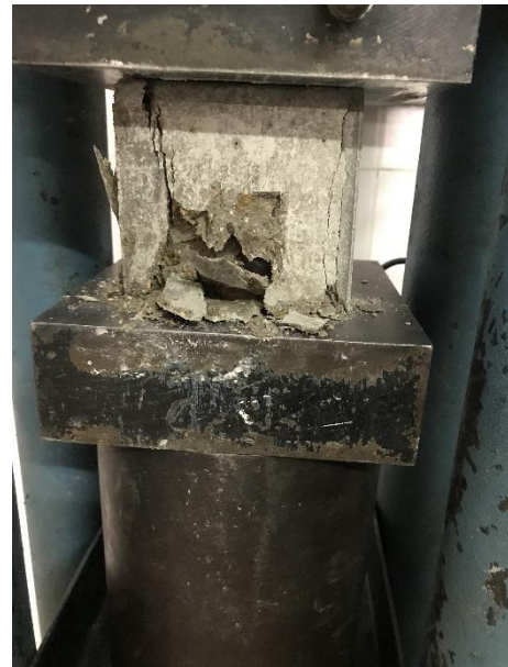
Imatge 77. Trencament de proveta sense fibra a compressió. Font: pròpia
