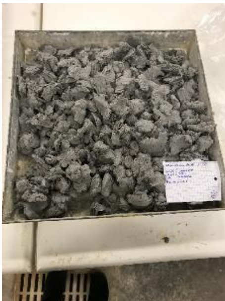
Imatge 7. Fibra de paper centrifugada i triturada manualment, posada en safates per assecar a l'estufa. Font: Pròpia
