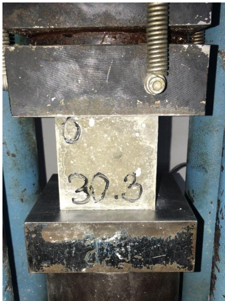
Imatge 76. Proveta col·locada per el trencament. Font: pròpia
