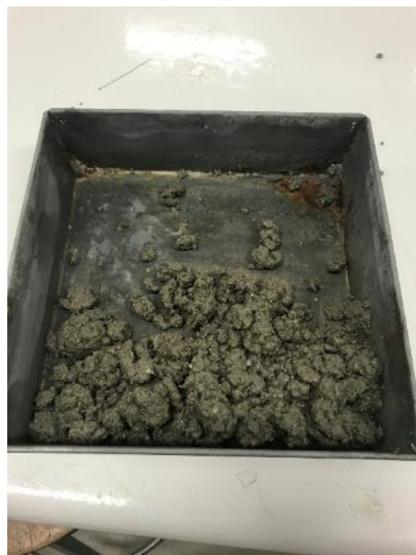
Imatge 41. Mostra del morter autoanivellant amb una relació AC 1/2 i un 10% de fibra. Font: pròpia
