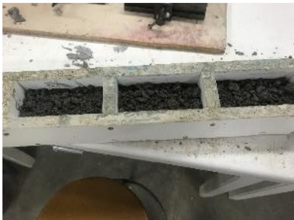
Imatge 30. Formació de la proveta de ciment amb fibra per tongades. Font: pròpia
