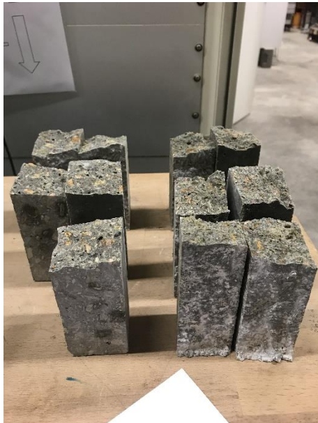
Imatge 100. Provetes després del trencament. Dreta 6%, Esquerra 3%. Font: pròpia
