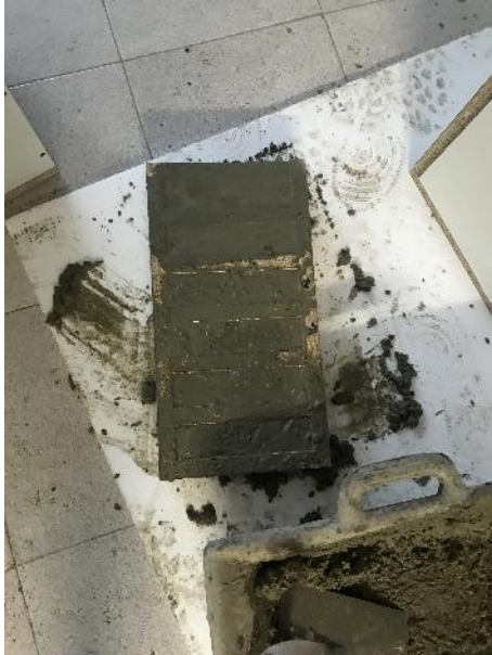
Imatge 91. Formigonat de les provetes per flexió. Font: pròpia
