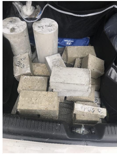
Imatge 106. Provetes per assaig tèrmic passat 7 dies dins la banyera. Font: pròpia
