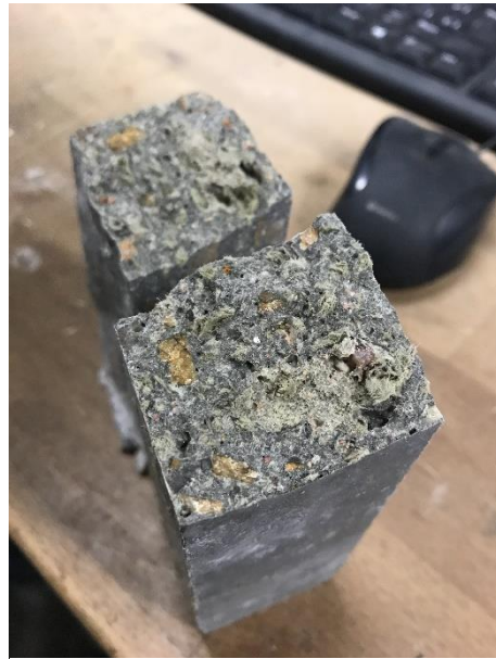
Imatge 99. Detall del trencament de la proveta amb un 6% de fibra. Font: pròpia
