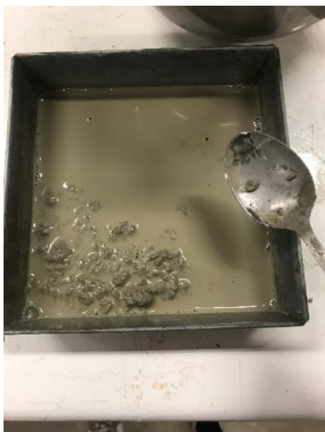
Imatge 49. Mostra del morter autoanivellant amb una relació AC 1/1 i un 3% de fibra. Font: pròpia
