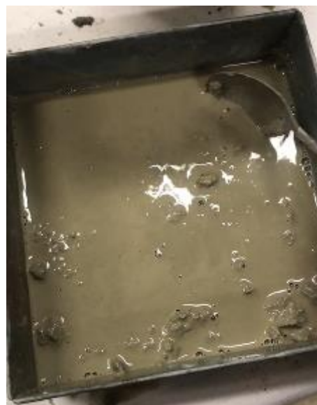
Imatge 50. Mostra del morter autoanivellant amb una relació AC 1/1 i un 3% de fibra amb fluidificant. Font: pròpia
