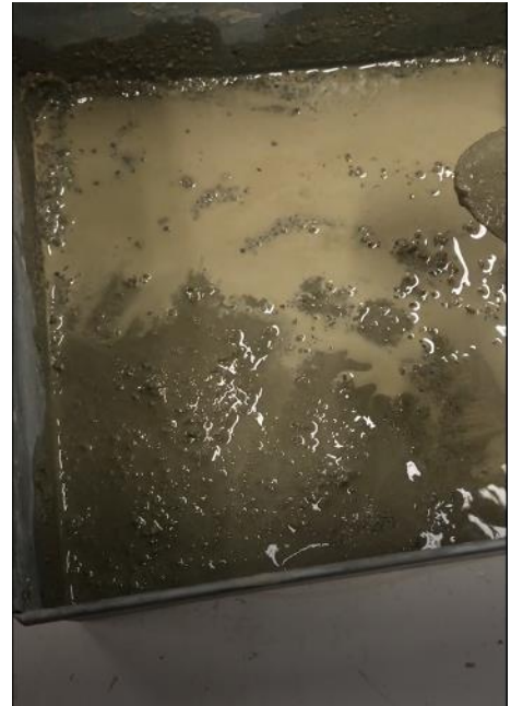
Imatge 39. Mostra del morter autoanivellant amb una relació AC 1/3 i un 0% de fibra i fluidificant.
