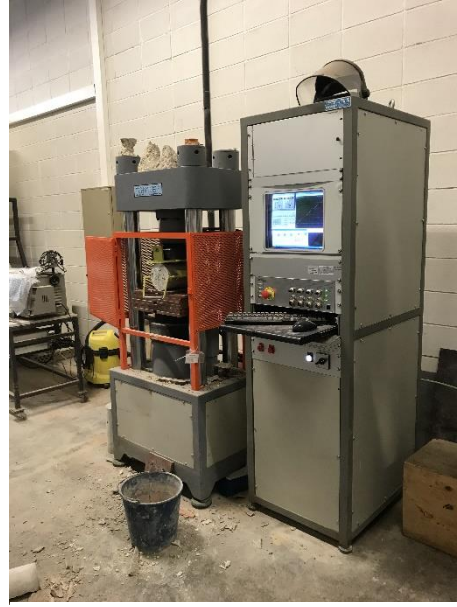
Imatge 84. Premsa hidràulica i adaptadors per suportar la peça cilíndrica. Font: pròpia
