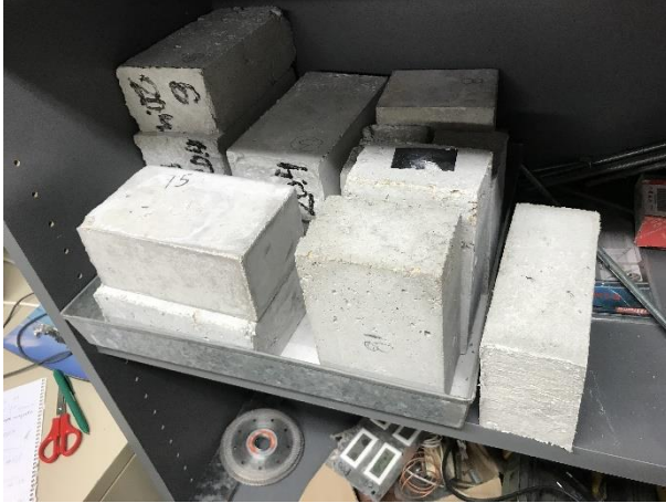
Imatge 110. Provetes per estudiar els efectes tèrmic de diferents dimensions i dossificacions. Font: pròpia
