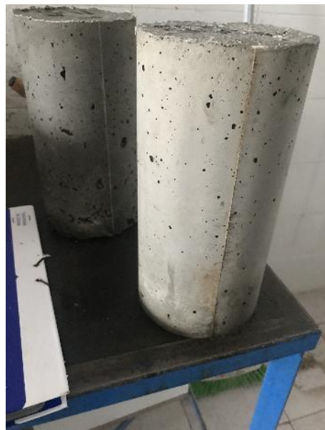
Imatge 82. Provetes de tracció amb fibra 48 hores posteriors a l'extracció de la banyera. Font: pròpia
