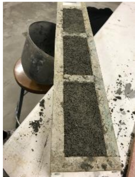
Imatge 32. Provetes de ciment i fibres preparades per curar. S'observa falta d'aigua. Font: pròpia
