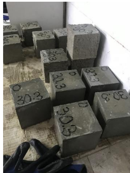
Imatge 69. Provetes just extretes de la banyera s'observa que encara estan humides.
