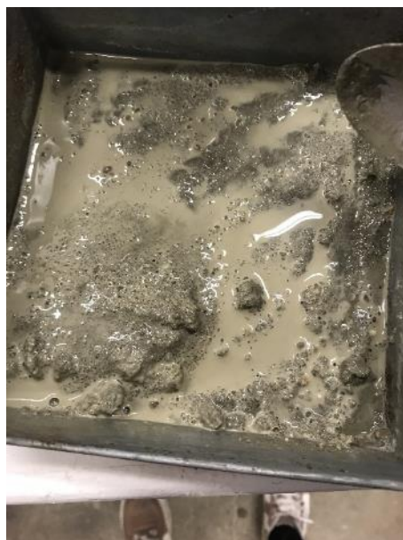
Imatge 48. Mostra del morter autoanivellant amb una relació AC 1/1 i un 3% de fibra. Sense molta aigua. Font: pròpia
