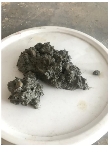
Imatge 66. Massa de formigó amb fibres on s'observa una bona consistència tal com marca la normativa.
