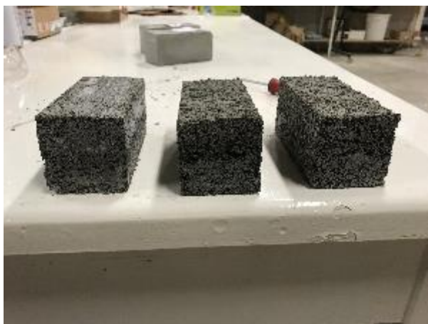
Imatge 31. Desemmotllat de les provetes de ciment amb un 10% de fibra. Font: pròpia
