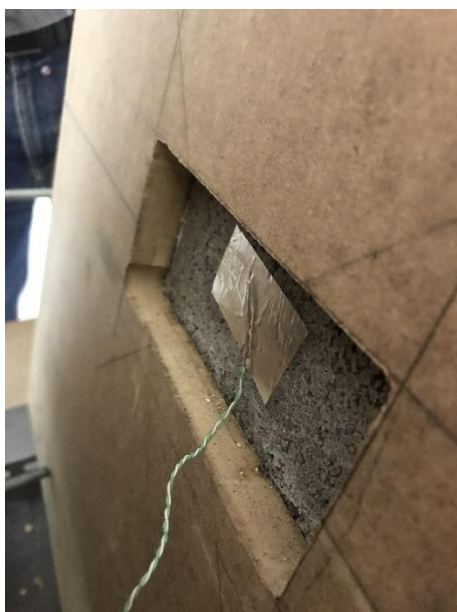
Imatge 36 Termopad connectat a una de les cares de la proveta. Font: pròpia
