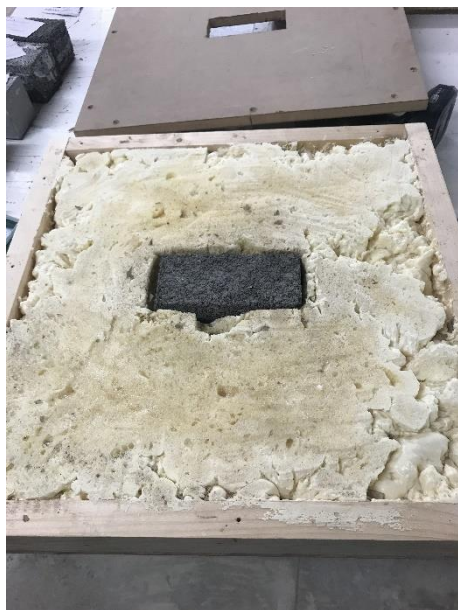
Imatge 32. Provena de ciment introduïda dins el motlo de fusta reomplent de poliuretà. Font: pròpia
