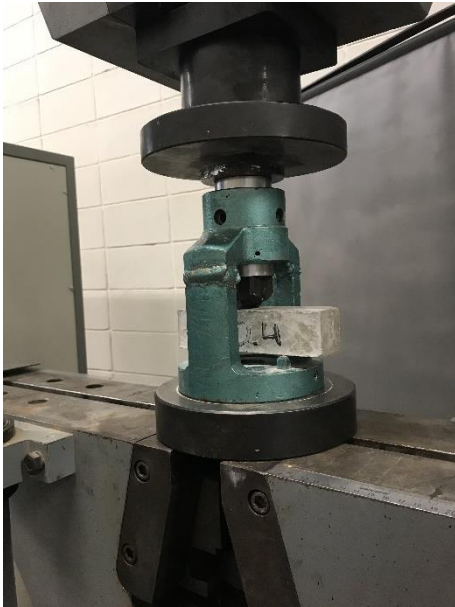
Imatge 96. Adaptador per l'assaig a flexió. Font: pròpia
