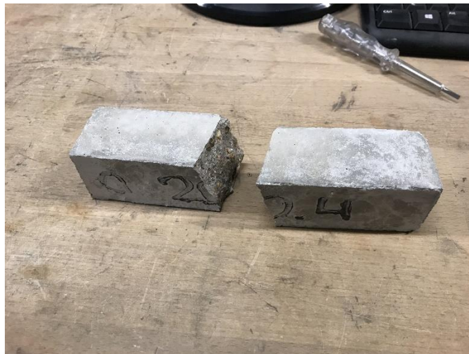
Imatge 101. Proveta amb un 0% de fibra després del trencament a flexió. Font: pròpia
