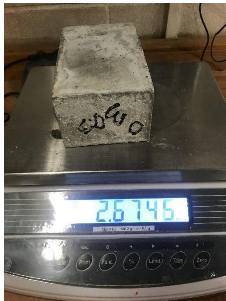
Imatge 107. Control de pes per conèixer si ha anulat tota l'humitat de la peça. Font: pròpia
