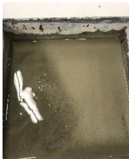
Imatge 38. Mostra del morter autoanivellant amb una relació AC 1/3 i un 0% de fibra.
