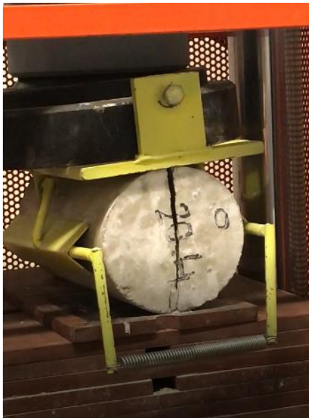
Imatge 86. Trencament a tracció produït a la proveta amb un 0% de fibra. Font: pròpia
