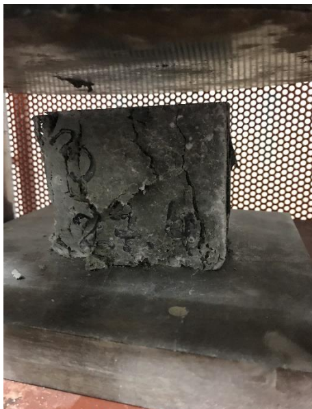
Imatge 78. Trencament de proveta amb fibra a compressió. Font: pròpia
