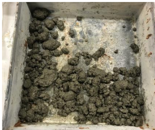
Imatge 42. Mostra del morter autoanivellant amb una relació AC 1/3 i un 5% de fibra. Font: pròpia
