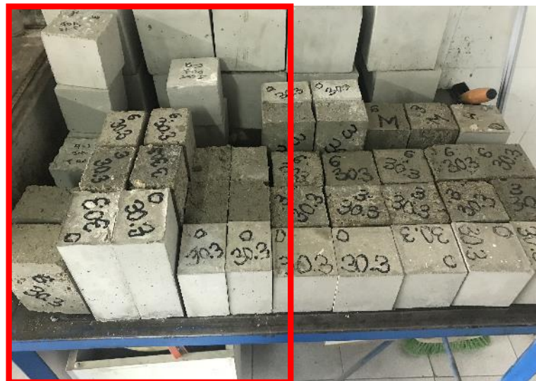
Imatge 104. Desenmollat de provetes per assaig tèrmic (dins el recuadre) Font: pròpia
