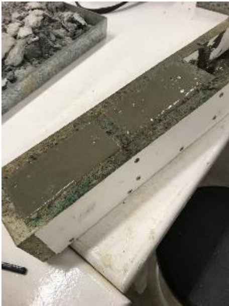
Imatge 24. Formació de les provetes de ciment dins el motlle. Font per posterior col·locació a la cambra humida i finalment a l'estufa i aconseguir un total assecatge:: pròpia
