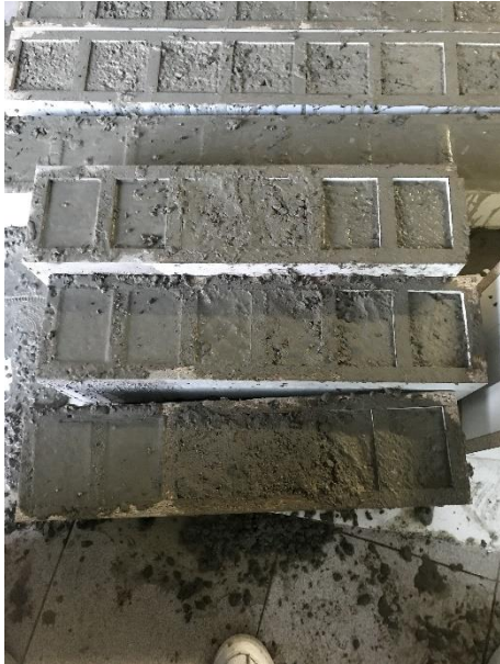
Imatge 102. Formigonat provetes per assaig tèrmic.. Font: pròpia
