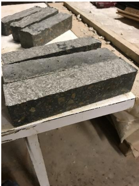
Imatge 94. Provetes per flexió amb fibra just extretes de la banyera. Font: pròpia
