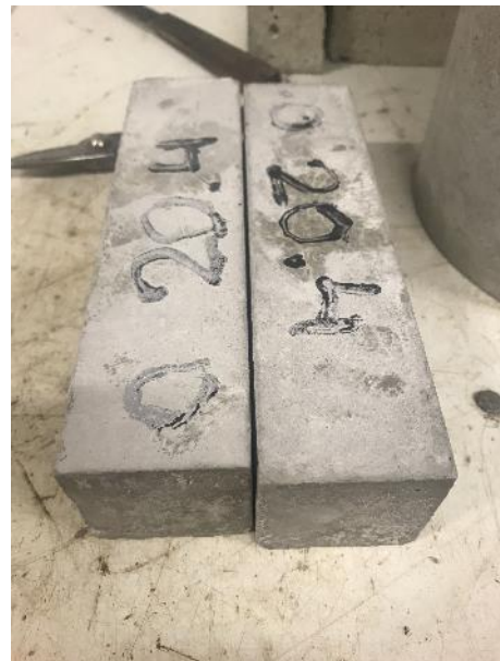
Imatge 93. Provetes per flexió sense fibra totalment curades als 28 dies. Font: pròpia
