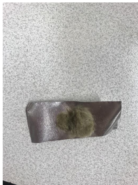
Imatge 39. Cinta aïllant amb llana de roca. Font: pròpia
