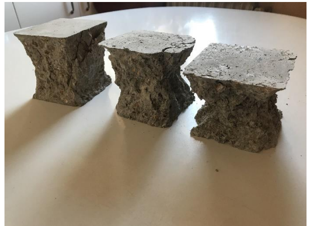
Imatge 79 Trencament correcte per l'assaig de compressió de les provetes a analitzar. D'esquerra a dreta 0 – 3 – 6 successivament. Font: pròpia
