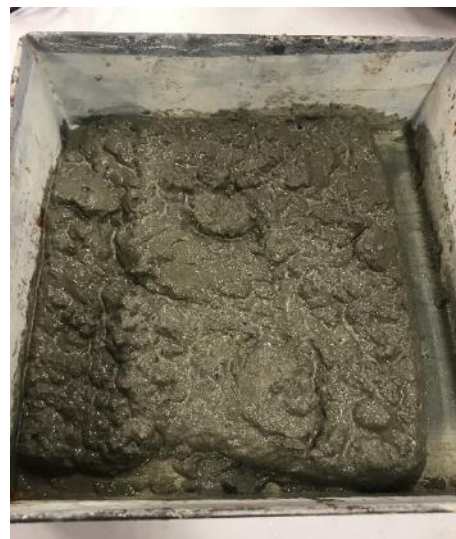
Imatge 43. Mostra del morter autoanivellant amb una relació AC de 1/2 i amb un 5% de fibra.
