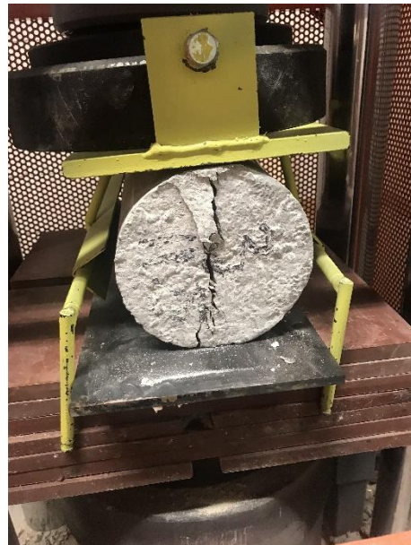
Imatge 87. Trencament a tracció produït a la proveta amb un 3 % de fibra. Font: pròpia
