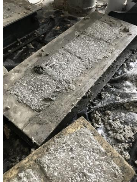
Imatge 67. 24 hores després del formigonat de les provetes de compressió.
