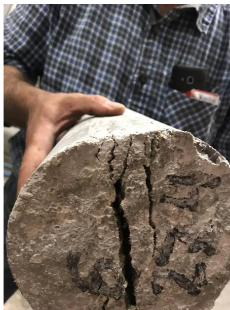
Imatge 88. Aixefament produït a la proveta amb una addició de fibra del 3%. Font: pròpia
