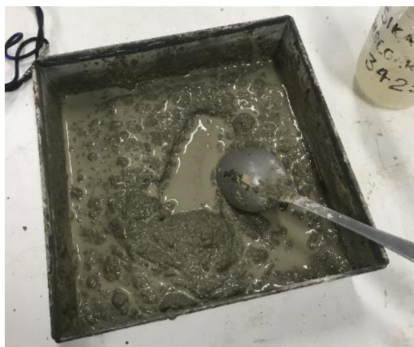
Imatge 47. Mostra del morter autoanivellant amb una relació AC 1/2 i un 3% de fibra amb fluidificant.
