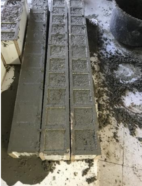
Imatge 68. Provetes de l'assaig de compressió amb el formigó fresc.
