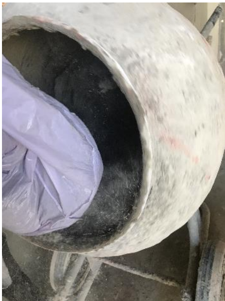
Imatge 64. Addició de la fibra de paper de diari al formigó. Font: pròpia
