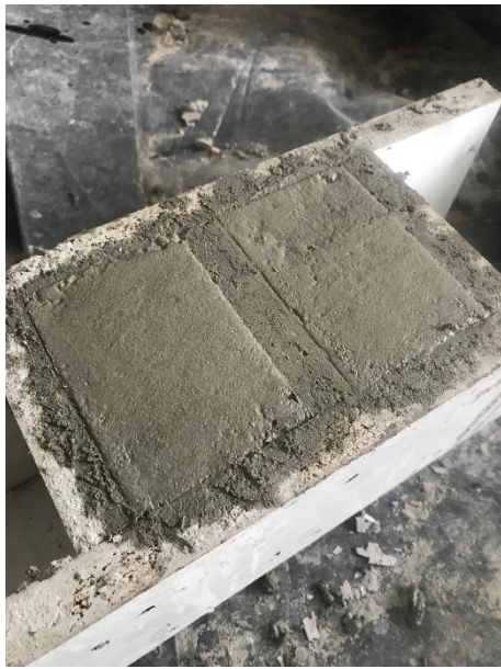
Imatge 105 Formigonat de provetes per assaig tèrmic amb un 3% de fibra. Font: pròpia
