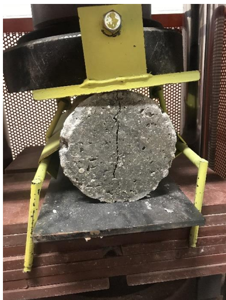
Imatge 89. Trencament a tracció produït a la proveta amb un 6% de fibra. Font: pròpia
