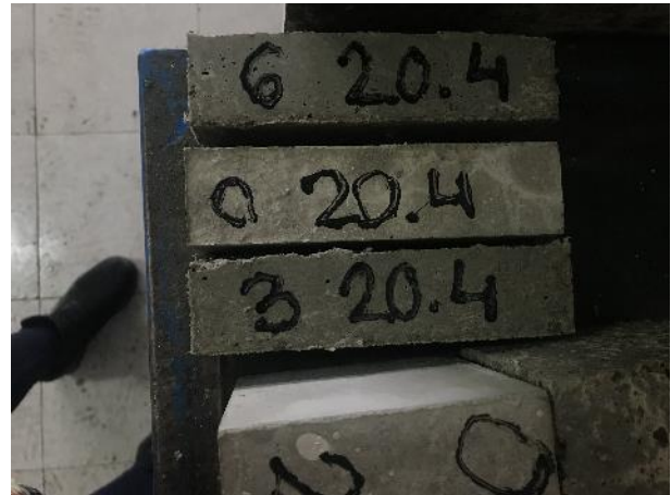
Imatge 92. Desenmotllat de provetes per flexió. Comparació de les 3 dosificacions de fibra. Font: pròpia
