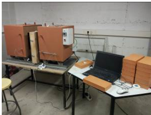
Figura 70. Equip complet de caixa tèrmica calibrada
