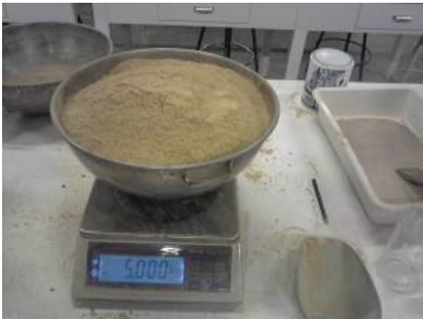
Figura 23. Pesat de l'argila (1)
