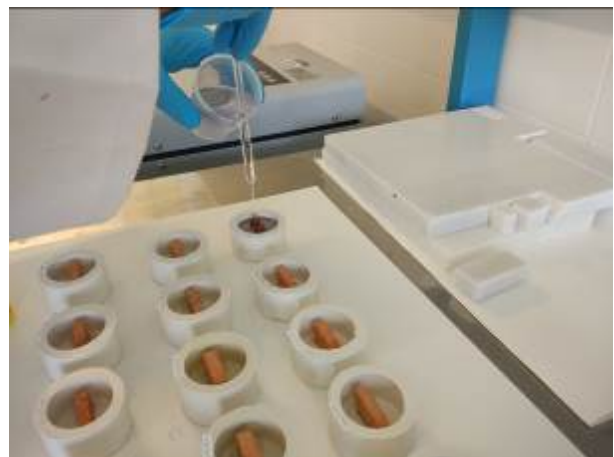
Figura 97. Emplenat de motlles amb la resina
