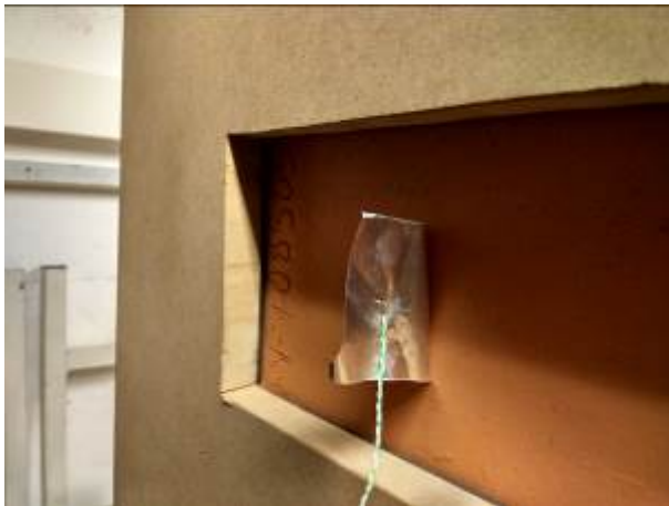
Figura 77. Col·locació de termoparell a cara freda
