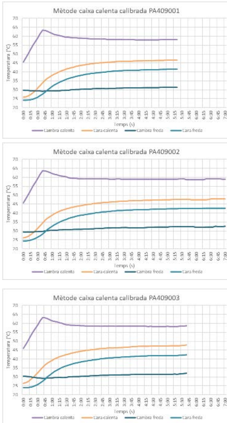
Gràfica 159. Gràfiques mètode de la caixa calenta calibrada PA40900_ (1)
