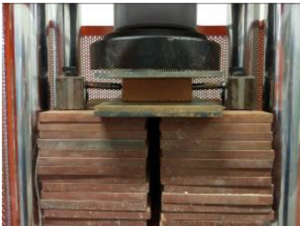
Figura 62. Provena i transductors col·locats a la premsa
