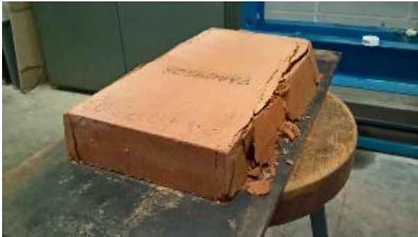
Figura 175. Assaig de resistència a compressió PF409004 (19)
