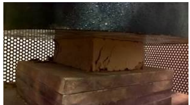
Figura 149. Assaig de resistència a compressió PF409004.1 (12)
