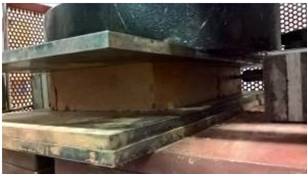
Figura 165. Assaig de resistència a compressió PF409004 (9)
