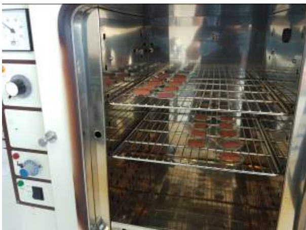
Figura 92. Assecat de mostres en estufa
