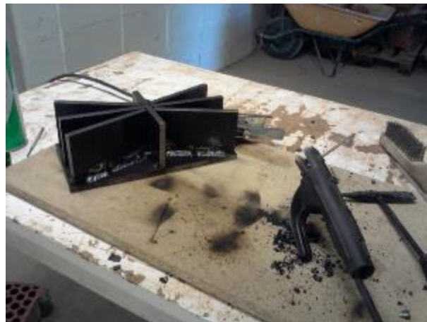
Figura 14. Procés de soldat de la platina reforçada
