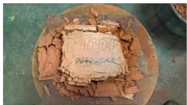
Figura 155. Assaig de resistència a compressió PF409004.1 (18)
