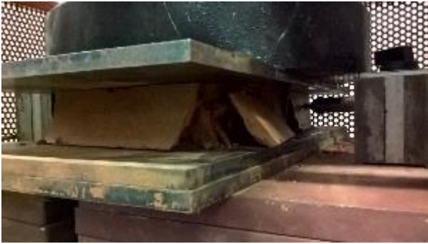
Figura 169. Assaig de resistència a compressió PF409004 (13)
