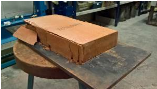
Figura 177. Assaig de resistència a compressió PF409004 (21)
