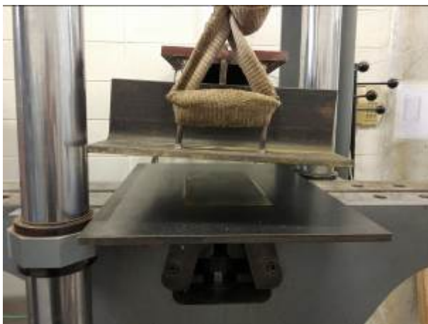
Figura 40. Elevat de motlle amb eslinga
