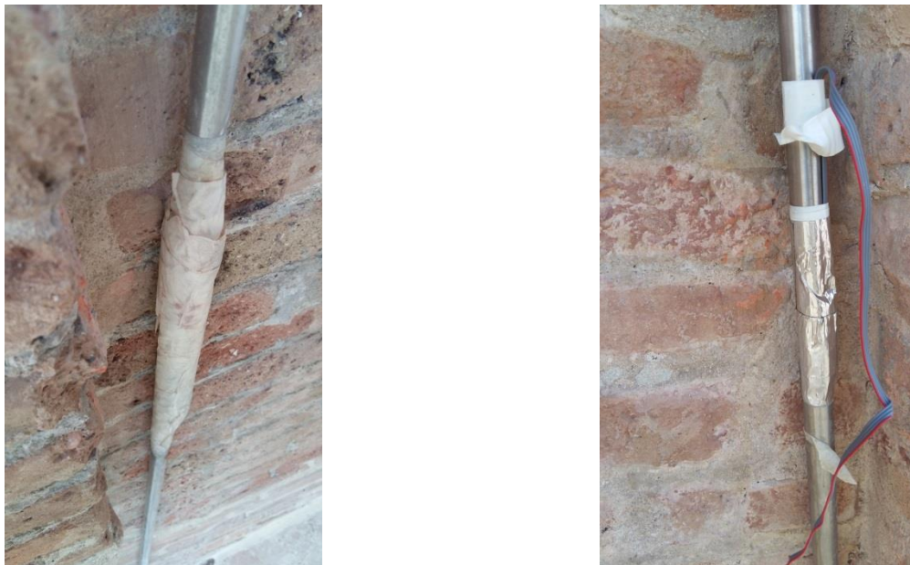
Figura 19: A l'esquerra, galga extensiomètrica protegida, i, a la dreta, descoberta
