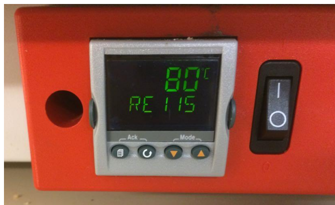
Fotografia 30 – En aquesta fotografia podem veure el forn a 80°C evaporant l'aigua de la dissolució
