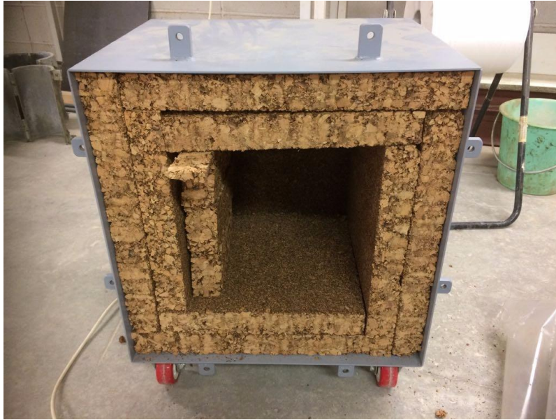
Fotografia 61 – Caixa tèrmica en procés de trasdossat d'aïllament
