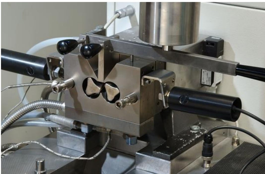
Fotografia 26 – Cavitat del reòmetre on s'hi introdueix el material
