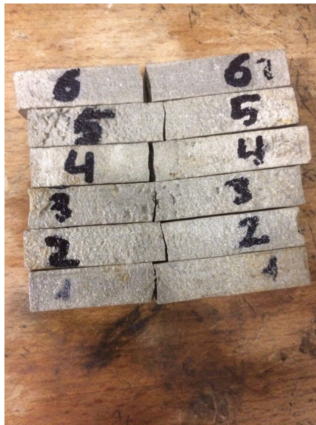
Fotografia 32 – Conjunt de provetes ja trencades a flexió
