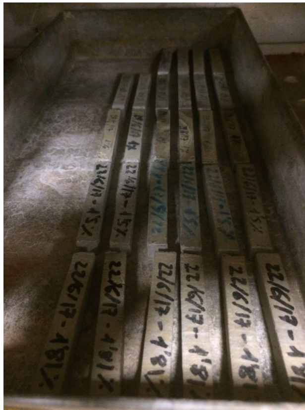
Fotografia 34 – En aquesta fotografia veiem algunes d'elles provetes dins el forn a una temperatura de 60°C
