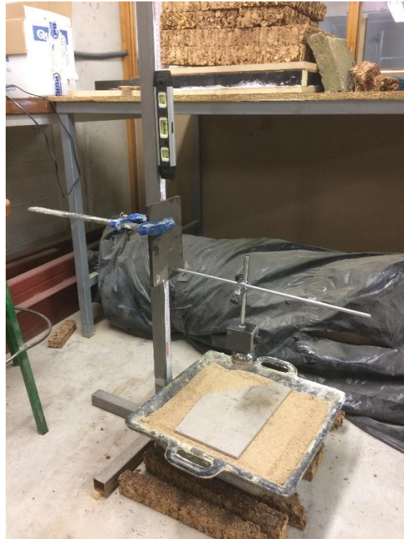
Fotografia 45 – Equip per a assaig de energia de ruptura
