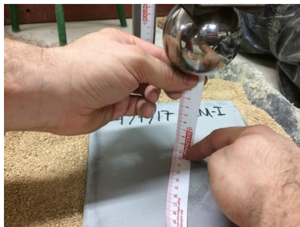
Il·lustració 49 – Disposició proveta CEM 1 i comprovació alçada 100 mm.
