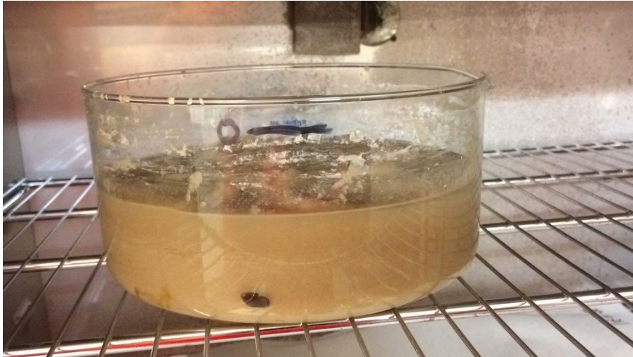
Fotografia 29 – En aquesta fotografia observem el cristal·litzador del que parlàvem amb la marca inicial abans de començar la concentració (dalt) i la marca on acabarà la concentració (baix).
