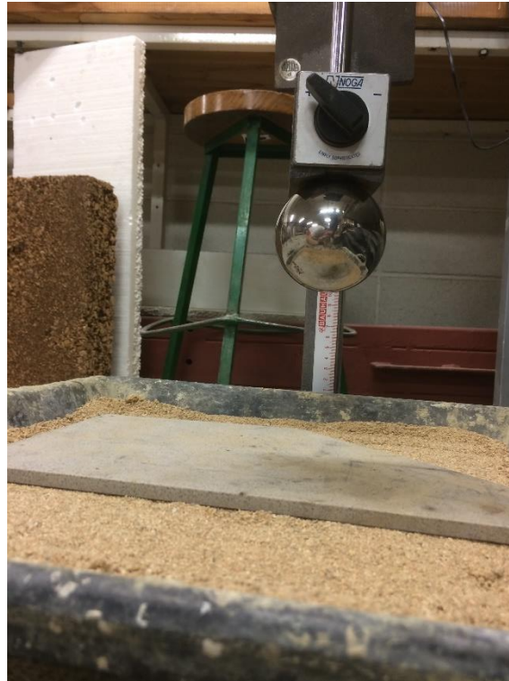
Fotografia 47 – Peu magnètic per a deixar anar la bola verticalment
