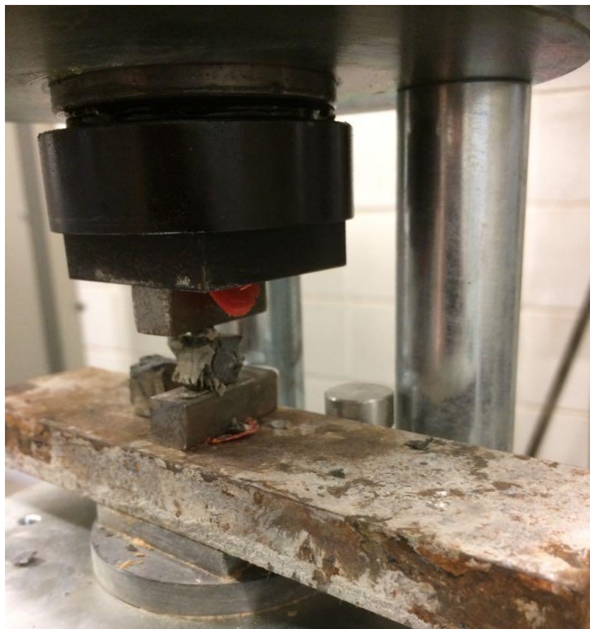
Fotografia 33 – Trencament de proveta a compressió
