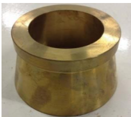
Fotografia 51 – Tronc de con normalitzat
