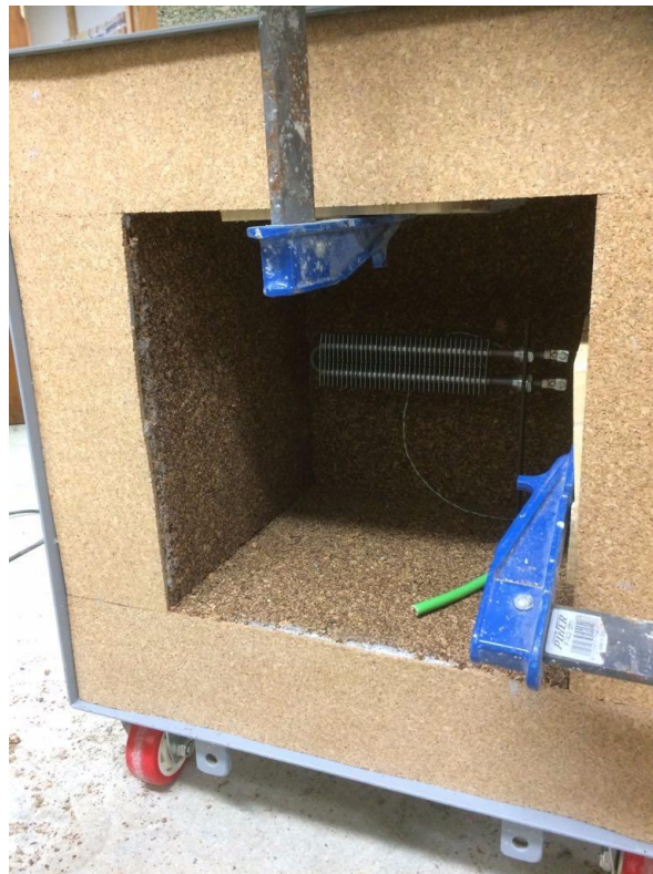
Fotografia 62 – Resistència ja instal·lada
