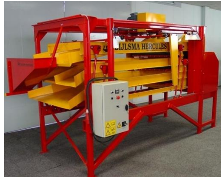
Figura 3.12. Classificadora segons calibre. (Font: BIJLSMA HERCULES, 2017)
