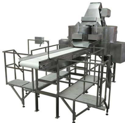
Figura 3.16. Cinta d'inspecció. (Font: TJF, 2017).
