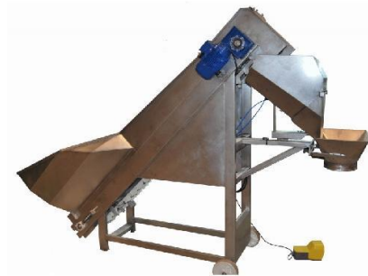
Figura 3.14. Pesadora de patates. (Font: TJF, 2017).
