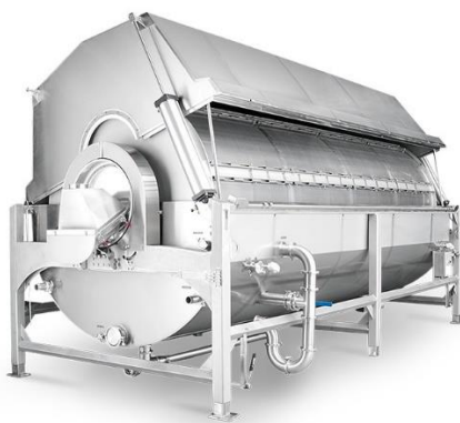
Figura 3.19. Escaldadora amb vapor. (Font: LYCOMFG, 2017).
