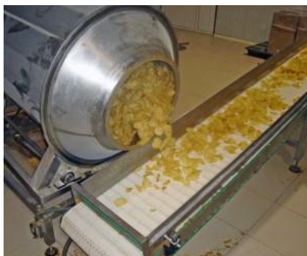
Figura 3.21. Bombo giratori per escórrer l'oli. (Font: EUROBELT, 2017).
