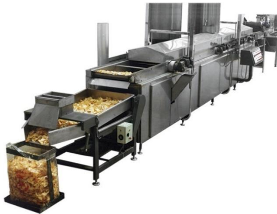
Figura 2.4. Fregidora continua de xips de la casa TJF. (Font: TJF, 2017).
