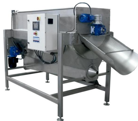
Figura 3.15. Peladora contínua. (Font: TJF, 2017).
