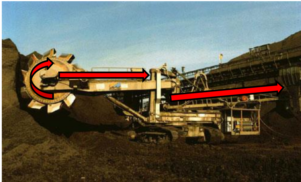
Figura 13. Excavadora de tipus rotor.
