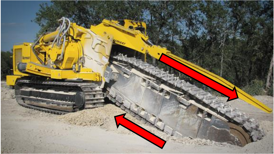
Figura 15. Excavadora de tipus rasadora.
