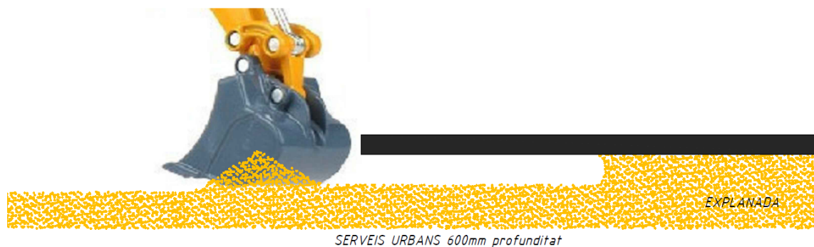
Figura 25. Retirada de terres.
