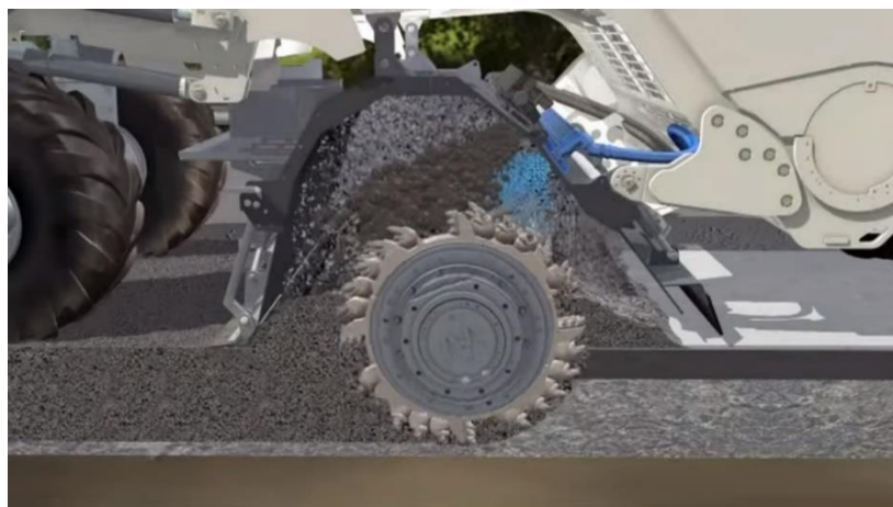
Figura 6. Trituració del paviment.
