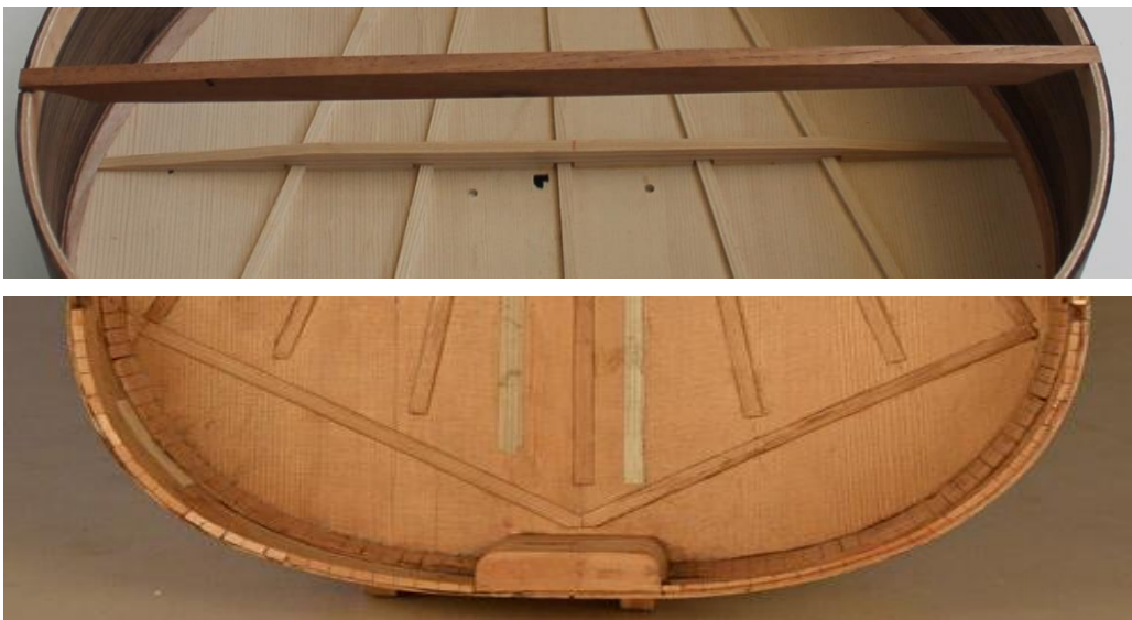
Figura 7 | Detall de les diferències entre el disseny de les barres harmòniques de la guitarra Camps i el disseny original d'Antonio Torres Jurado. Font: Pròpia / https://www.pinterest.es/pin/572731277605434443/
