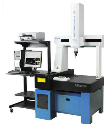
Figura 11 | Màquina de mesura de coordenades Mitutoyo Crysta Apex 544 amb la qual s'ha mesurat les dimensions de la caixa de ressonància del prototip. Font:
