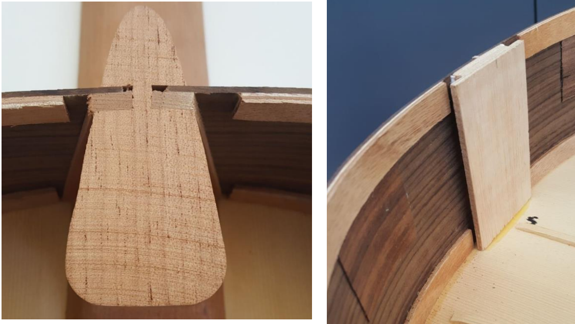
Figura 9 | Detalls de les diferents parts que componen els laterals de la caixa de ressonància de la guitarra. Font: Pròpia
