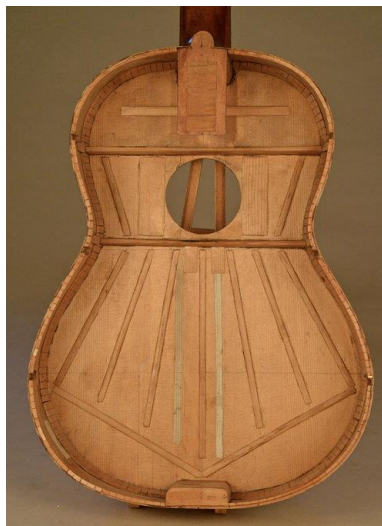
Figura 1 | Patró de les barres en la caixa de ressonància de la guitarra ideat per Antonio Torres Jurado. Font: https://www.pinterest.es/pin/572731277605434443/
