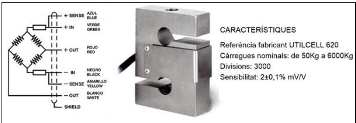
Figura 21 cèl·lula de càrrega, connexionat i característiques
