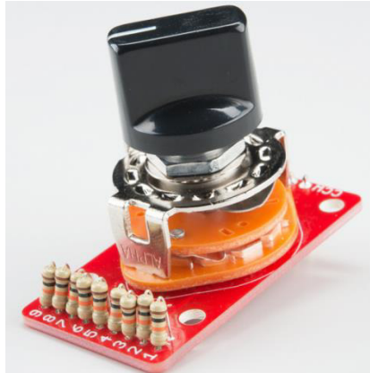
Figura 22. Placa amb interruptor rotatiu i resistències
