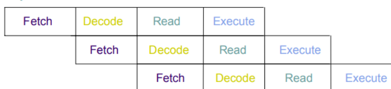
Figura 7. Representació del pipeline en DSP's
