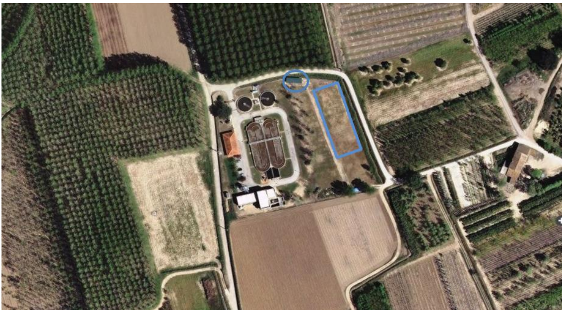
Figura 10. Vista aèria de l'Estació Depuradora d'Aigües Residuals de Celrà i la parcel·la annexa on es van desenvolupar els assajos. El cercle indica la localització del banc de filtració i el rectangle del camp de degoteig (ICGC, 2018).
