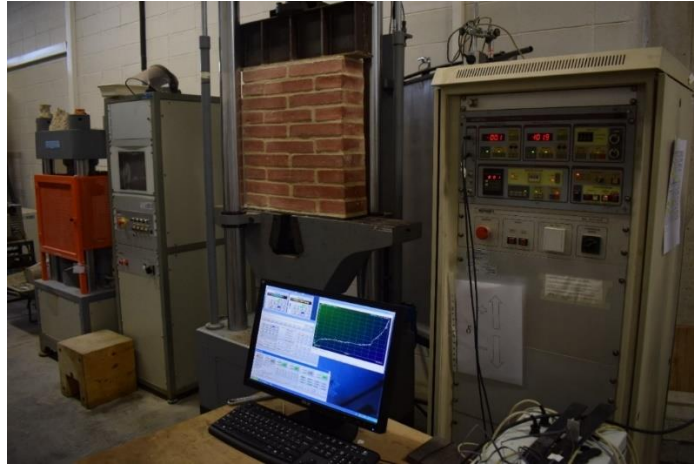
Imatge 122. Col·locació de la proveta d'obra de fàbrica 01 en la premsa.
