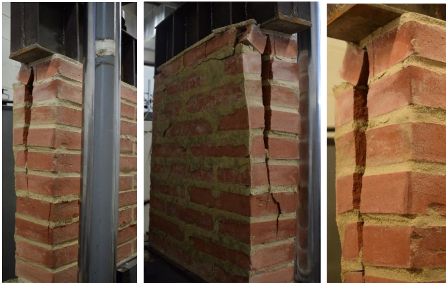
Imatges 130, 131 i 132. 130- Seguiment de les esquerdes que sorgeixen a la proveta d'obra de fàbrica 01, cantell (02). 131- Seguiment de les esquerdes que sorgeixen a la proveta d'obra de fàbrica 01, cantell (03). 132- Detall de les esquerdes de la cantonada de la proveta d'obra de fàbrica 01.
