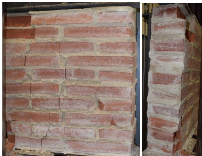
Imatges 035 i 036. 035- Estat final de la proveta en haver acabar l'assaig de cara. 036- Estat final de la proveta en haver acabar l'assaig de cantell.
