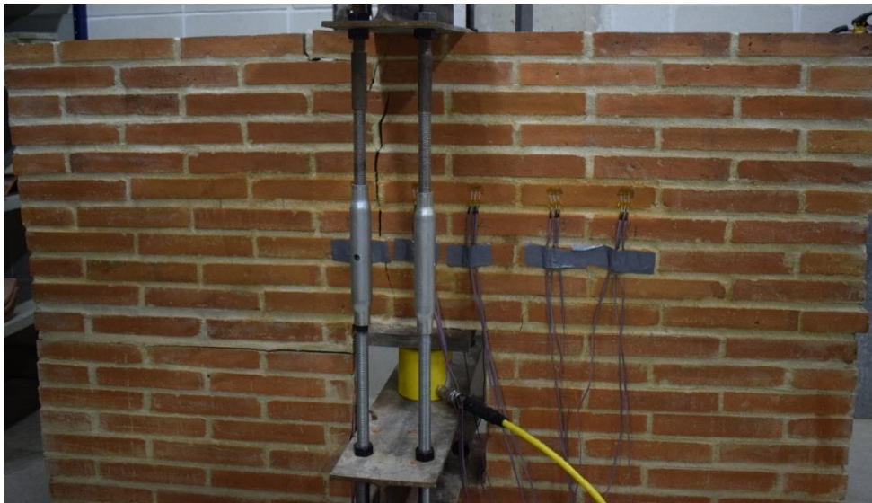
Imatge 209. Seguiment de les esquerdes que sorgeixen en el mur 03 (02).
