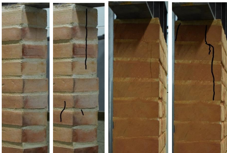
Imatges 142, 143, 144 i 145. 142- Seguiment de les esquerdes a la cantonada dreta de la proveta 02. 143- Remarcat de les esquerdes a la cantonada dreta de la proveta 02. 144- Seguiment de les esquerdes a la cantonada esquerra de la proveta 02. 145- Remarcat de les esquerdes a la cantonada esquerra de la proveta 02.
