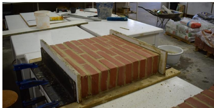
Imatge 085. Construcció de la proveta 03.
