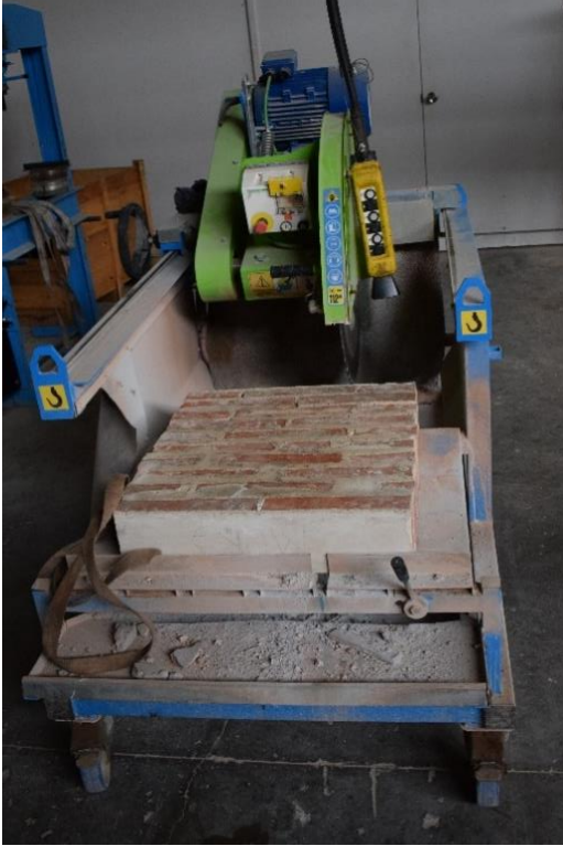
Imatges 135 i 136. 135- Tall de la proveta d'obra de fàbrica 02 (01). 136- Tall de la proveta d'obra de fàbrica 02 (02).
