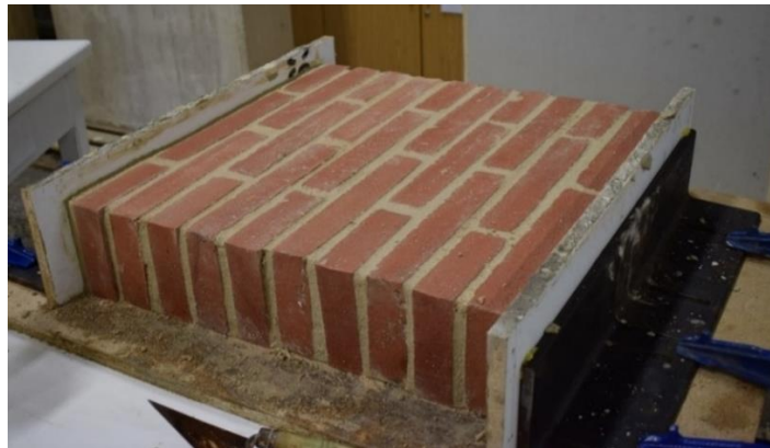
Imatge 075. Construcció de la proveta 01 (01).
