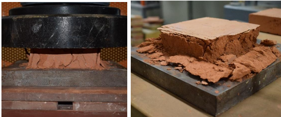
Imatges 050 i 051. 050- Assaig de la peça 02. 051- Estat final de la peça 02 (01).
