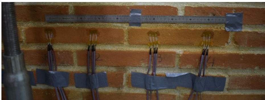
Imatge 121. Col·locació de les galgues extensiomètriques al mur 03.
