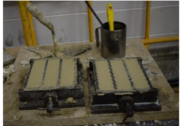
Imatges 064 i 065. 064 - Construcció de la base del mur 03, fase 1 (01). 065- Demostració de la realització de les provetes de morter.
