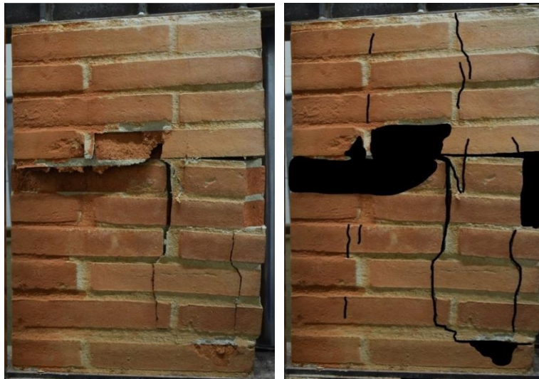
Imatges 146 i 147. 146- Estat final de la proveta 02. 147- Remarcat de les esquerdes aparegudes en la proveta 02 ja assajada.
