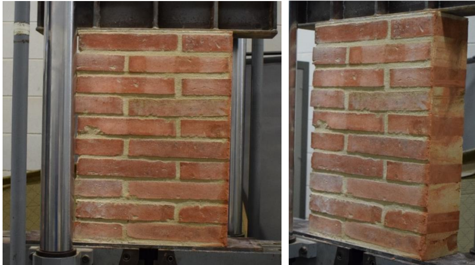
Imatges 152 i 153. 152- Col·locació de la proveta d'obra de fàbrica 03 en la premsa (01). 153- Col·locació de la proveta d'obra de fàbrica 03 en la premsa (02).
