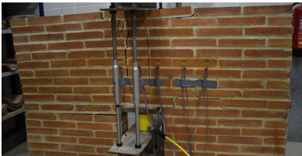
Imatge 211. Seguiment de les esquerdes que sorgeixen en el mur 03 (03).
