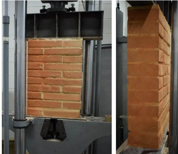
Imatges 138 i 139. 138- Col·locació de la proveta d'obra de fàbrica 02 en la premsa (01). 139- Col·locació de la proveta d'obra de fàbrica 02 en la premsa (02).
