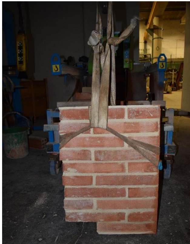
Imatges 137. Tall de la proveta d'obra de fàbrica 02 (03).
