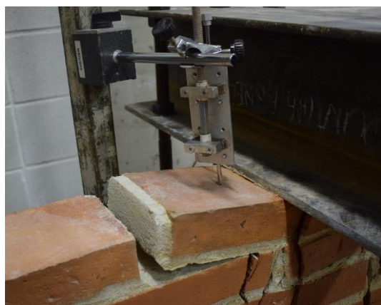
Imatge 182. Aixecament de la peça que es procedia a estudiar amb el transductor de desplaçament vertical.
