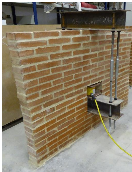
Imatges 107 i 108. 107- Equip utilitzat per instrumentar el mur 01. 108- Col·locació dels elements en el mur 01.
