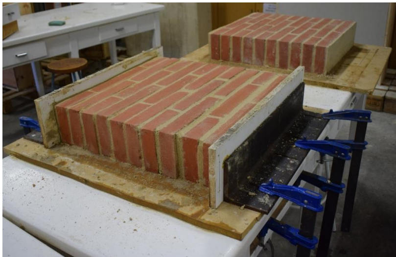
Imatge 080. Construcció de la proveta 02 [proveta davantera], al costat de la proveta 01 [proveta posterior] .
