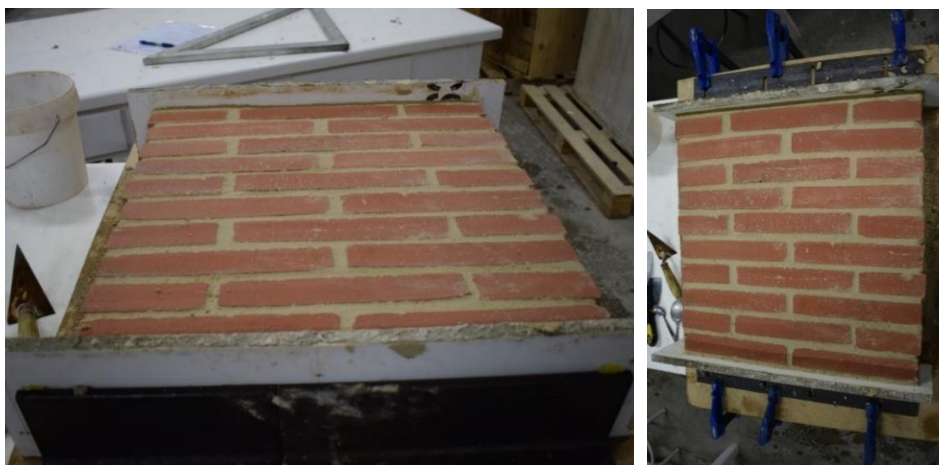
Imatges 076 i 077. 076- Construcció de la proveta 01 (02). 077- Construcció de la proveta 01 (03).
