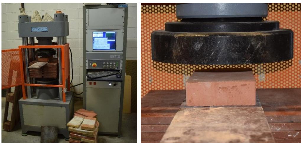
Imatges 042 i 043. 042- Premsa utilitzada per assajar les peces ceràmiques. 043- Col·locació de una peça ceràmica en la premsa.
