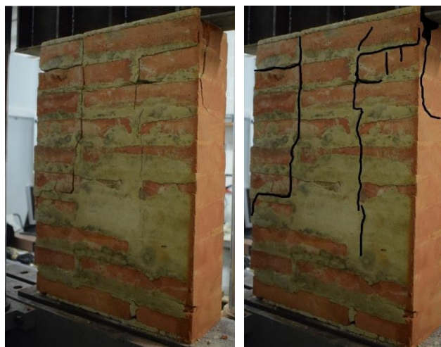
Imatges 150 i 151. 150- Estat final de la proveta 02 en la para posterior. 151- Remarcat de les esquerdes aparegudes en la proveta 02 en la cara posterior ja assajada.
