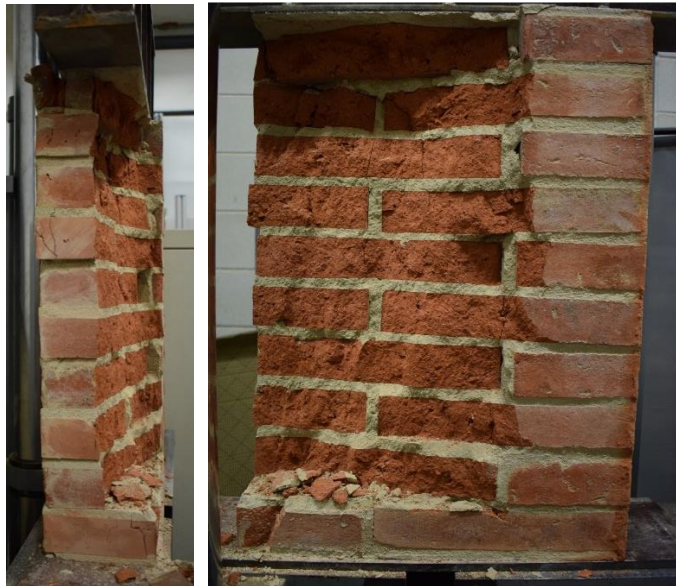
Imatges 160 i 161. 160- Estat final de la proveta d'obra de fàbrica 03 en la cantonada esquerra. 161- Estat final de la proveta d'obra de fàbrica 03.
