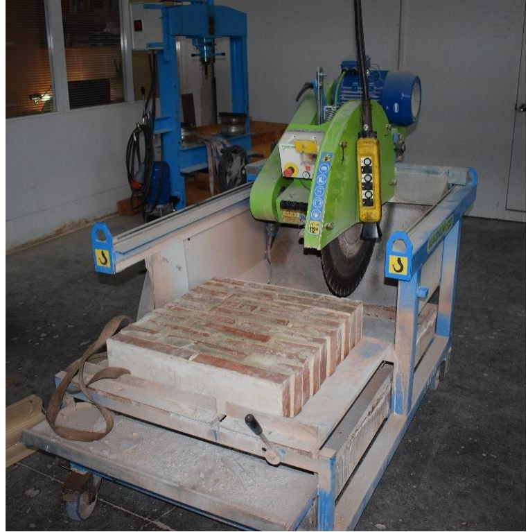
Imatges 135 i 136. 135- Tall de la proveta d'obra de fàbrica 02 (01). 136- Tall de la proveta d'obra de fàbrica 02 (02).
