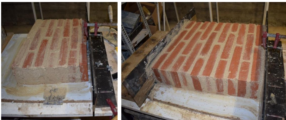
Imatge 022 i 023. 022- Construcció de la proveta a forma de prova. 023- Proveta a forma de prova.
