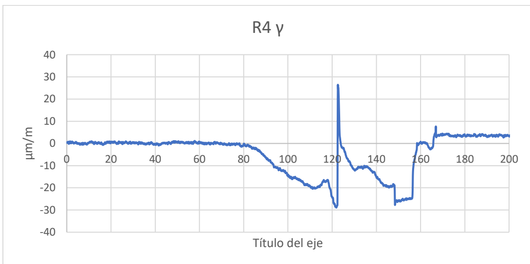
Gràfica 064. Valor de la deformació tallant en el pla ( \gamma_{xy} ) de la roseta R4
