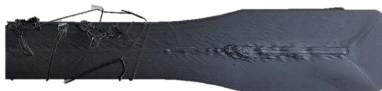
Figura 40: Defecte d'excés de material a l'extrem de la proveta
