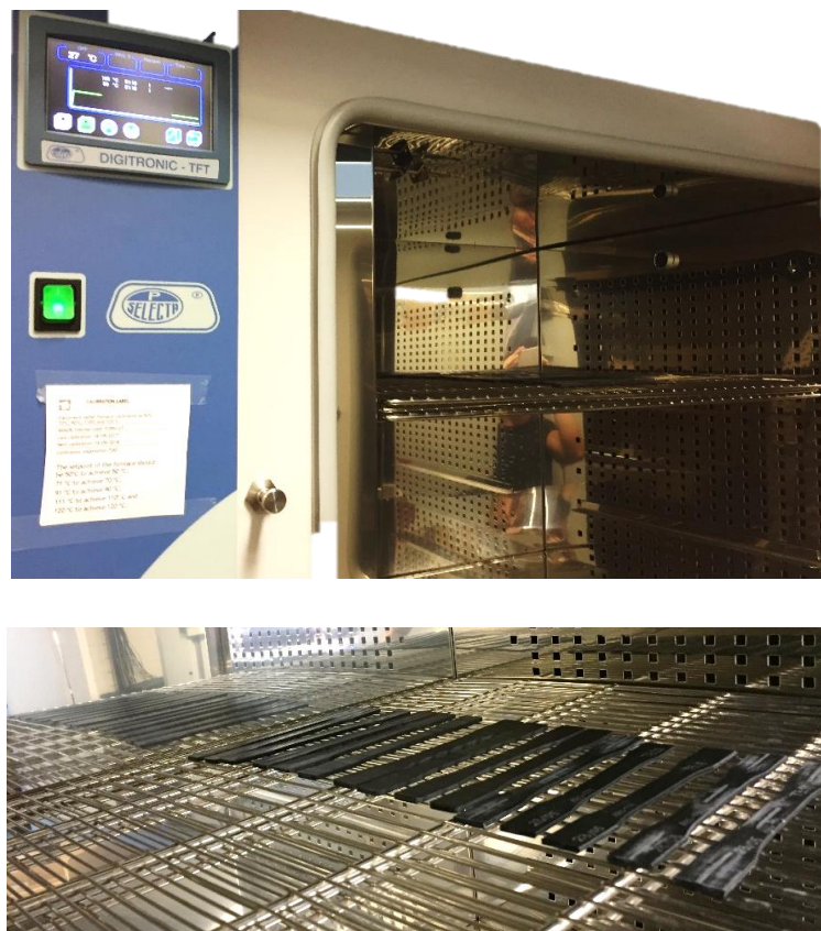
Figura 31: Forn utilitzat amb les provetes abans de tractar
