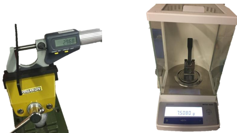
Figura 33: Micròmetre i bàscula utilitzada per mesurar cada proveta
