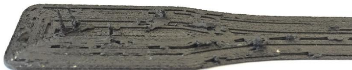
Figura 42: Defecte d'acumulació de material pel refredament del nozzle
