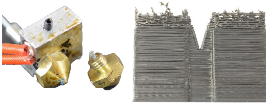
Figura 41: Defecte d'obstrucció de l'extrusor
