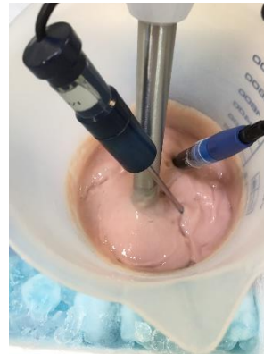
Figura 3.5 Salmorra elaborada, amb les sondes del termòmetre i del pH-metre que mesuren T^a i pH.
