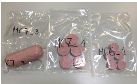
Figura 3.14 Model carni cuit sencer, llesques obtingudes (1.5cm) i mostres definitives per al TPA (ordre d'esquerra a dreta).
