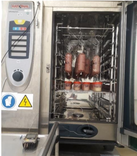
Figura 3.11 Col·locació de les salmorres i els models carnis al forn per a dur a terme el procés de cocció amb control de temperatura.
