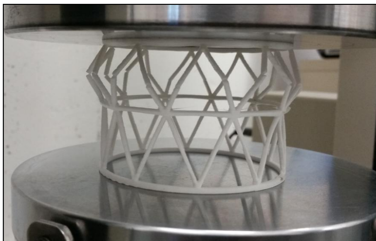
Figura 49: Proveta col·lapsa degut al trencament de les barres del pis superior.
