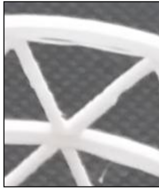
Figura 20: 1ª passada de la 1ª capa del pont desenganxada
