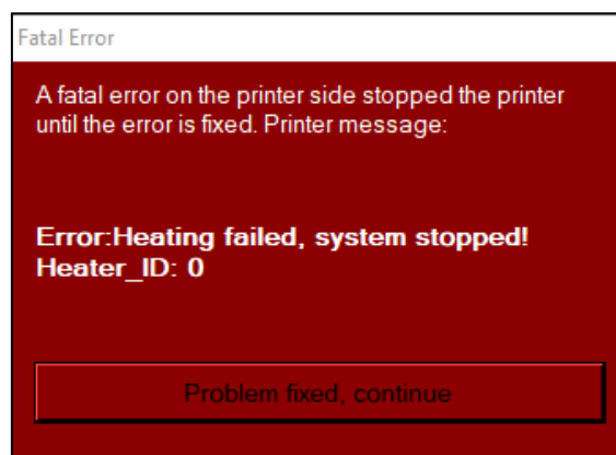
Figura 34: Error de temperatura de l'extrusor
