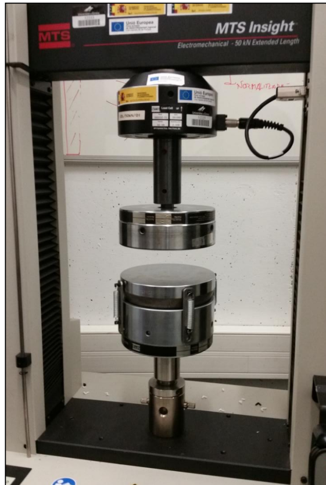
Figura 46: Màquina utilitzada per l'assaig, MTS Insight (Electromechanical 50 kN - Extended Length)
