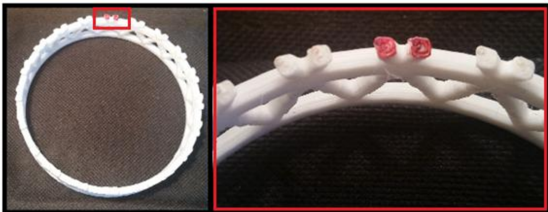
Figura 70: Espais buits que deixa la impressora a l'hora d'imprimir les barres
