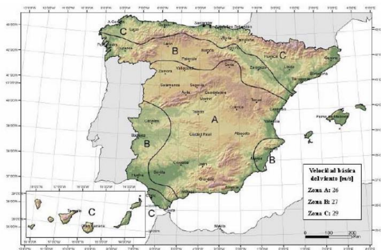
Fig.2. Distribució zones geogràfiques per la determinació de la velocitat del vent
