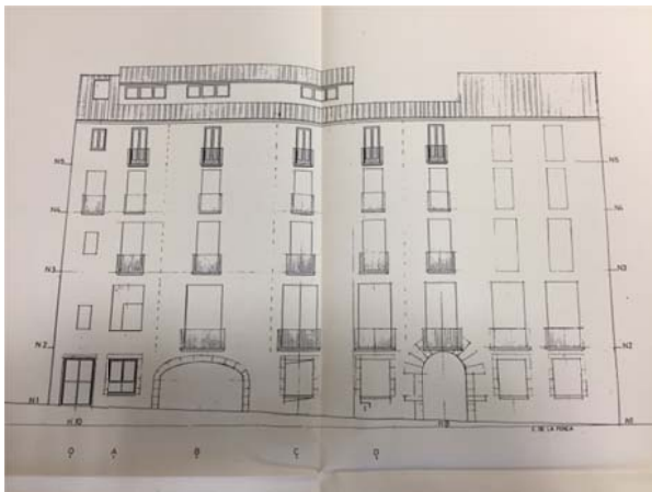
Fig. 6.17.2. Plànol de projecte de façana abans de la intervenció. Font: Ajuntament de Girona
