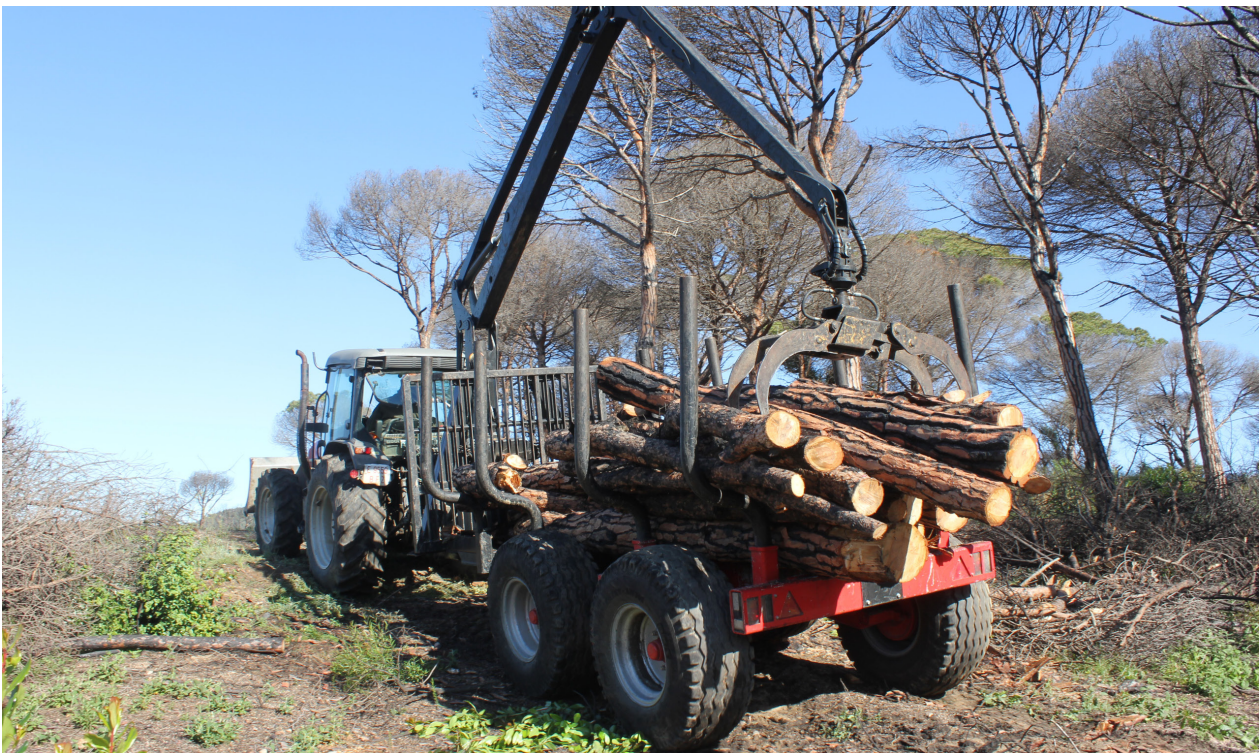
FIGURA 6. Desembosque en calle mediante tractor y remolque autocargador ligeros. Imagen: P. Pons.
