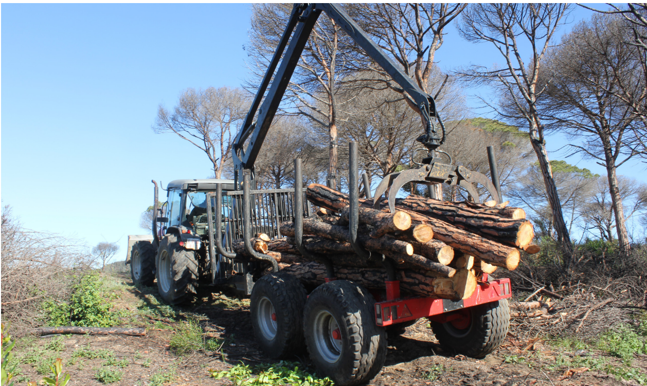
FIGURA 6. Desembosc sobre carrer amb conjunt lleuger de tractor i remolc amb autocarregador. Imatge: P. Pons.
