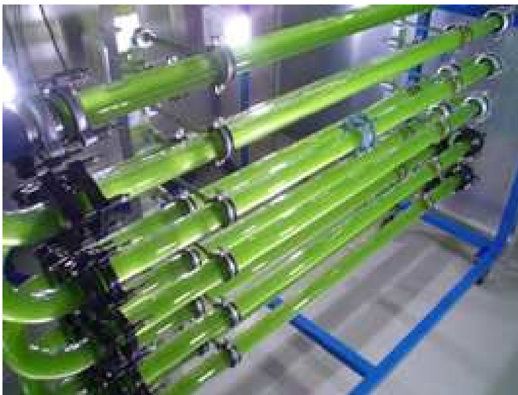
Fotobiorreactor amb llum artificial Font: www.cci-calidad.com/articulos689.htm
