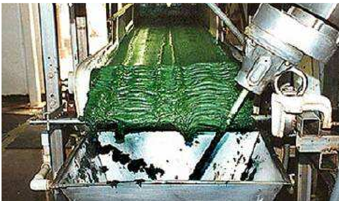
Recuperació de microalgues per filtració. Font: Chisti Y.; Biodiesel from microalgae . Biotechnology Advances 25 (2007) 294-306.
