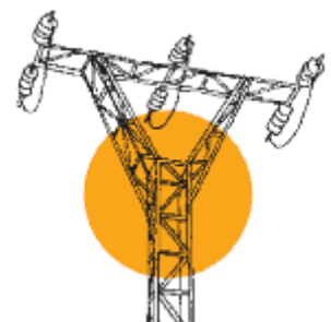
Suports d'ancoratge amb pont central per sota dels aïlladors propers a la xona on es
