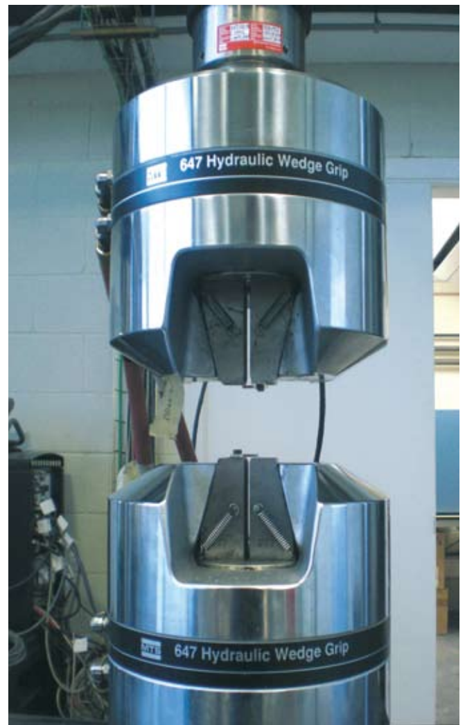
■ Aparell per mesurar la resistència a la compressió i a l'extensió del material
