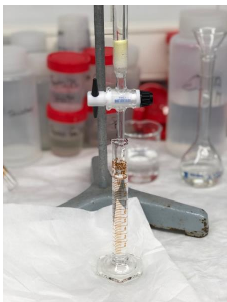
Figura 2: Exemple de columna on es realitzar l'estudi de determinació en continu de metalls barrejats.
