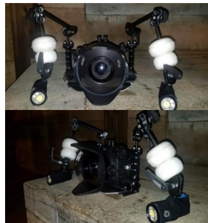
Figura 11. Càmera Canon 5DMARK III, amb objectiu Canon 17-40 IF, caixa estanca i llums submarins Focus Explorer Pro utilitzats per a fer les fotografies nocturnes. (Peña, A. 2018)
