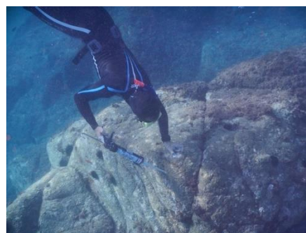
Figura 17. Col·locació de la massilla de polièster sobre una estació d'estudi, mitjançant una pistola de silicona. (Peña, A. 2017)
