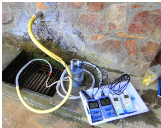
Figura 12. Cel·la de flux i aparells utilitzats en el treball de camp. Font: Soler, 2018.
