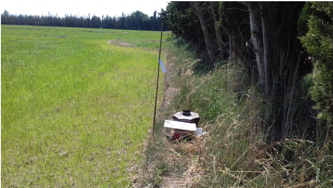
Figura 3. Exemple de muntatge de la trampa a l'Estació 10. La capsa conté la bateria i el regulador, i la tapa es va pintar de blanc per evitar que se sobreescalfés amb el sol. Font pròpia.
