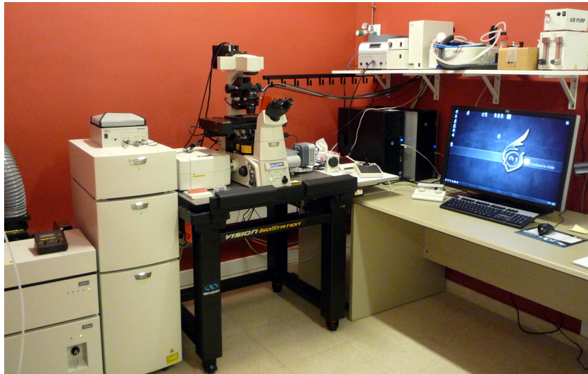
Figura 15. Microscopi Làser confocal utilitzat per observar fibroblasts (3T3) adherits a la cel·la d'un stent . Es troba a la Unitat de Biotecnologia i Biomedicina dels Serveis Tècnics de la Universitat de Girona (fotografia pròpia).
