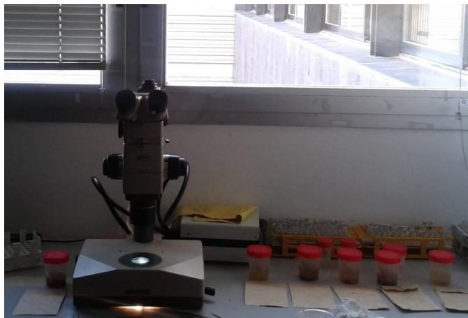
Figura 6. Imatge on s'observa la instrumentació emprada, l'estereomicroscopi i la font externa de llum halogenada, per a la detecció dels otòlits. També s'hi observen alguns pots, degudament rotulats, que contenen les diferents egagròpiles. Autora: Anna M a Fuentes, 2018.
