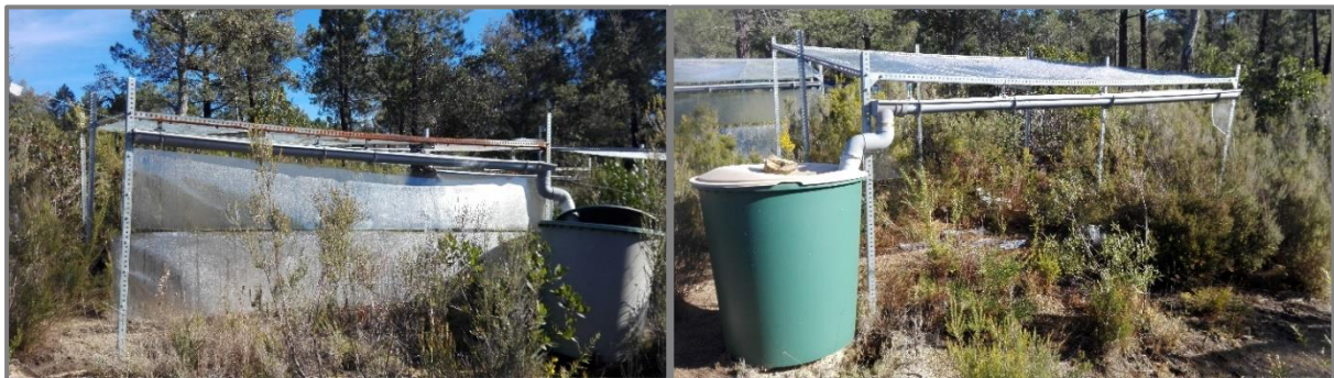
Figura 3. Parcel·les i estructures situades a la zona d'estudi amb els seus respectius bidons per recol·lectar l'aigua.
