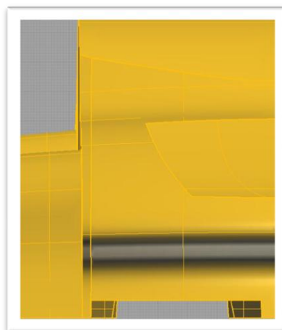
Fig. 4.18. – Detall frontal: a) Sense caixa d'aire – b) Modificació amb caixa d'aire.
