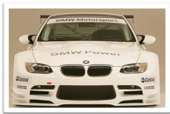
Fig. 4.17. – Comparació faldons davanters: a) vehicle de carrer i b) vehicle de competició.
