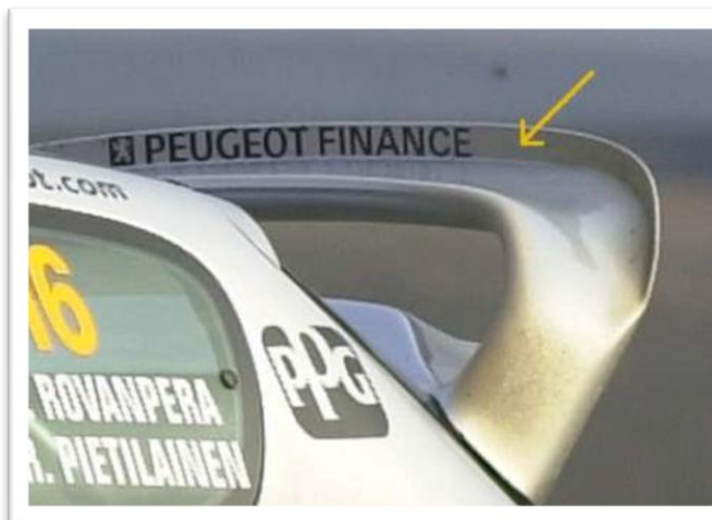
Fig. 4.24. – Detall Flap Gurney: a) Aleró vehicle WRC i b) Aleró vehicle comercial.
