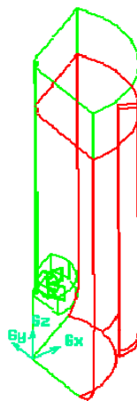
Figura 4.3. Cares d'origen per la Size Function de la tercera part de l'agitador de turбина de disc amb 3 deflectors.
