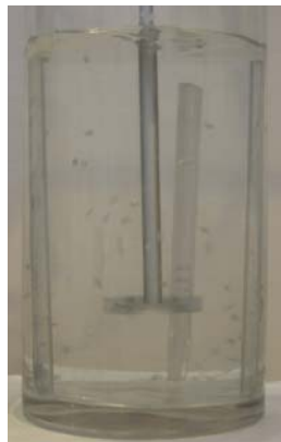
Figura 4.1. Agitació de la turbina de disc amb 3 deflectors a 800 rpm.
