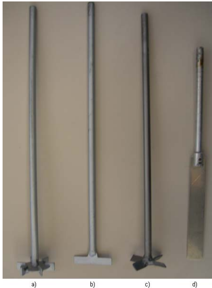
Figura 3.2. Impulsors usats per la validació: a) turbina de disc de 6 pales; b) turbina de 2 pales planes; c) turbina de 4 pales inclinades a 45°; d) paleta.
