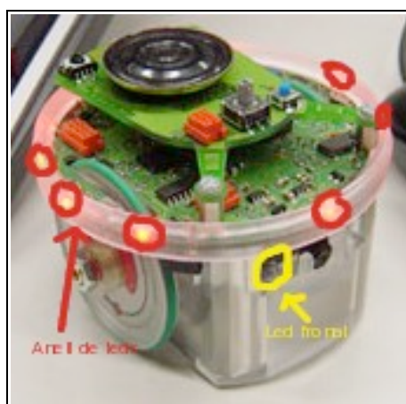
Figura 14: Robot e-puck amb el led frontal i uns quants leds del anell marcats.
