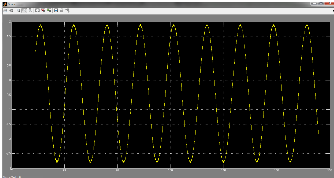
Figure 39: Angle pitch à la sortie oscillant selon l'entrée
