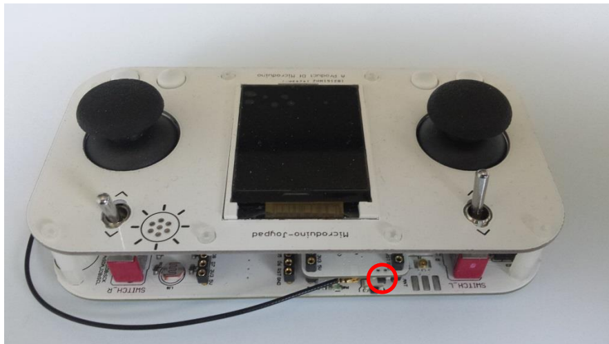
Figure 24: Joypad vue depuis l'autre côté et localisation du bouton reset
