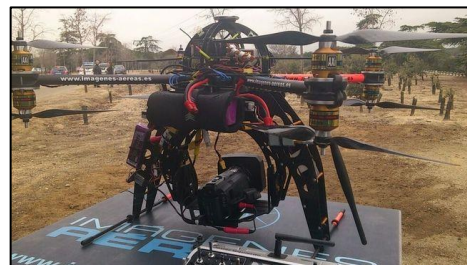
Imatge 2.9: Detall d'un UAV amb motor de gasolina. Imatge extreta de: http://www.infouas.com
