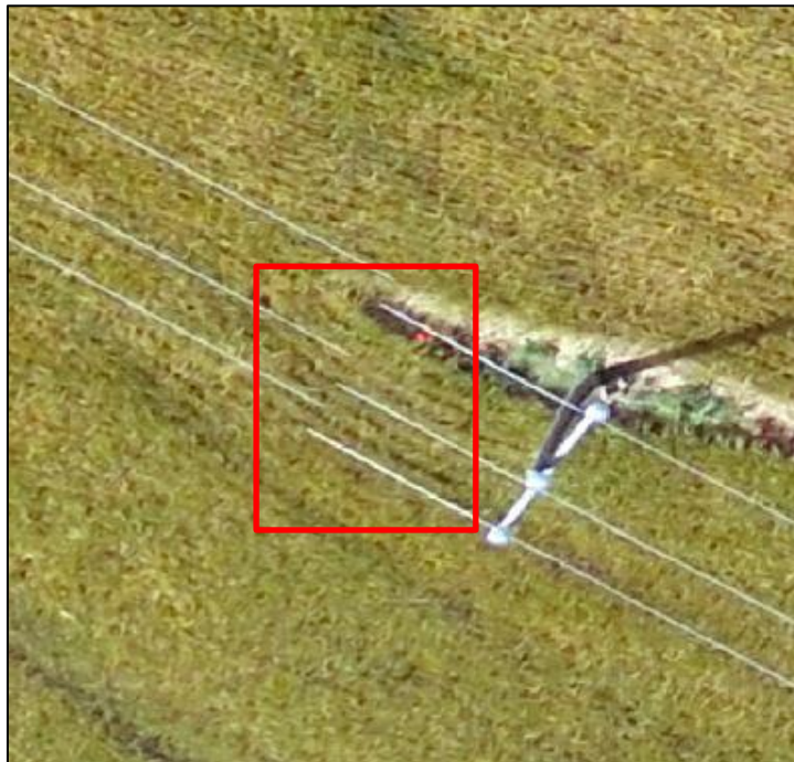
Imatge 4.1: Detall del error que es genera amb la línia elèctrica que traspasa l'àrea d'estudi
