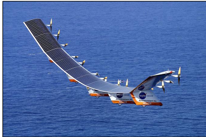
Imatge 2.10: UAV que funciona amb energia solar, model NASA Pathfinder (plus). Imatge extreta de: http://www.fiddlersgreen.net
