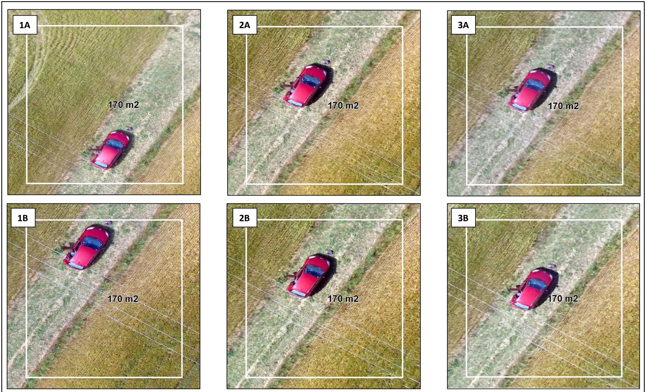
Imatge 4.2: Error en la georeferenciació per part dels programes de post vol
