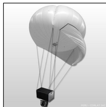
Imatge 2.4: UAV globus aerostàtic. Imatge extreta de: http://cl.pe/globo-videovigilancia-
