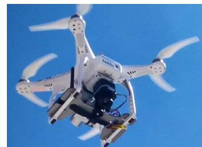
Il·lustració 36- Càmera tèrmica acoblada a un DJI Phantom. Font: http://www.analistgroup.com
