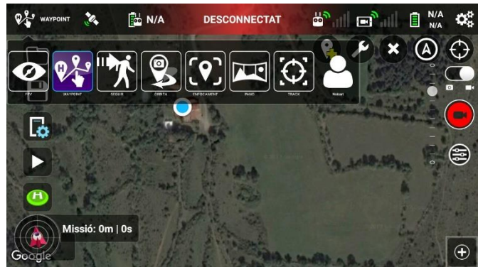
Il·lustració 50- Captura de pantalla on s'observen els diferents tipus de vol de l'aplicació Litchi. Font pròpia.
