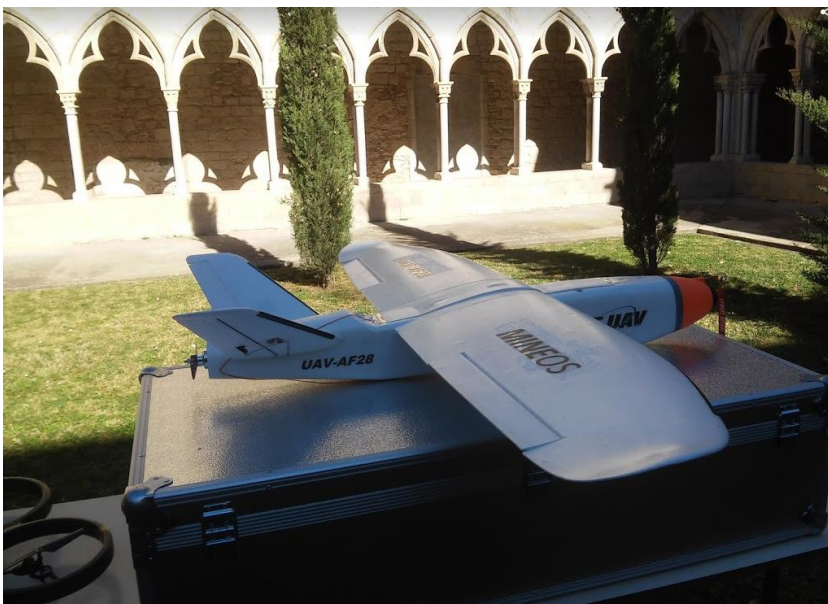
Il·lustració 1- Dron d'ala fixe del Departament de Geografia de la Universitat de Girona
