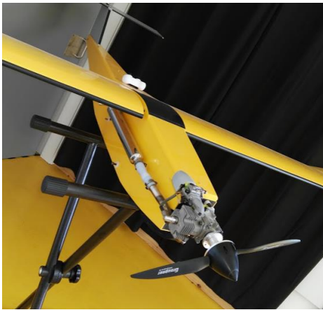
Il·lustració 8- Dron d'ala fixe impulsat per un motor d'explosió d'energia fòssil. Font pròpia.
