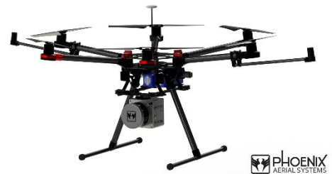
Il·lustració 38- Dron DJI S900 amb un sensor LIDAR de la marca Phoenix incorporat. Font: http://dronelife.com/wp-content/uploads/2017/01/aerial-scout.png
