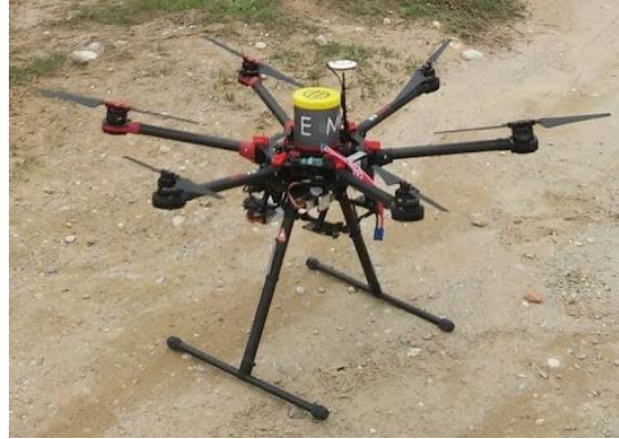
Il·lustració 11- Dron amb sistema de seguretat (paracaigudes) de l'empresa HEMAV. Font pròpia.
