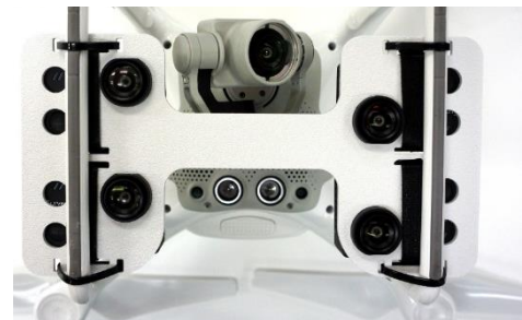
Il·lustració 35- Suport per acoblar als drons tipus DJI Phantom per poder-hi incorporar fins a 4 càmeres multiespectrals. Font: http://www.analistgroup.com
