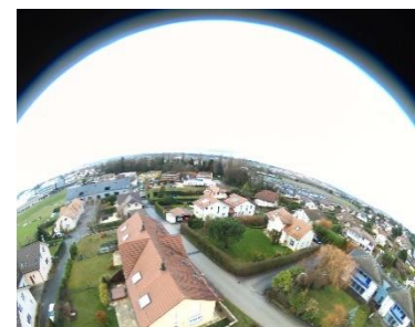
Il·lustració 25- Imatge presa des d'un sensor RGB amb la lent d'ull de peix. La informació de la imatge ha d'estar ven calibrada per conèixer ben bé quina és la seva distorsió amb la realitat. Font: http://www.pix4d.com
