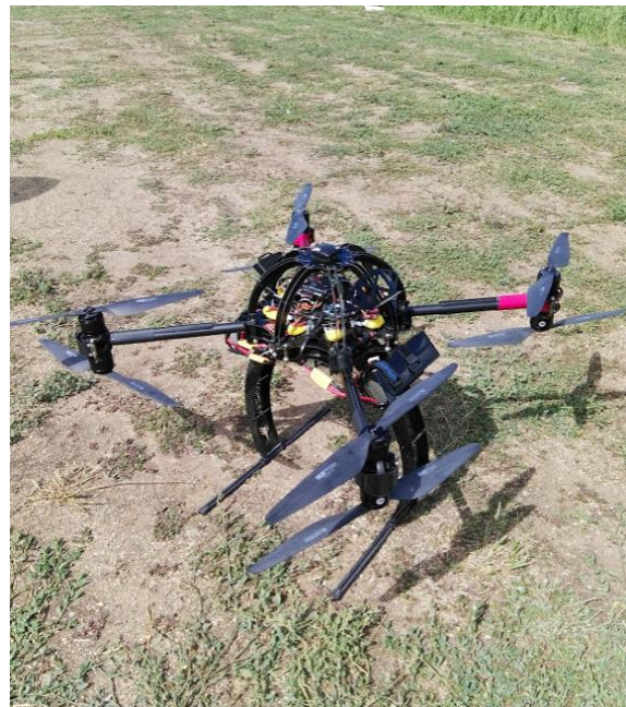
Il·lustració 13- Dron multirotor coaxial (dos motors per braç) amb l'electrònica adaptada per utilitzar en tasques de rescat.
