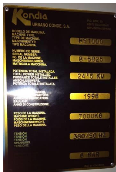
Fotografía 15 : Placa de los datos de la máquina i del fabricante
