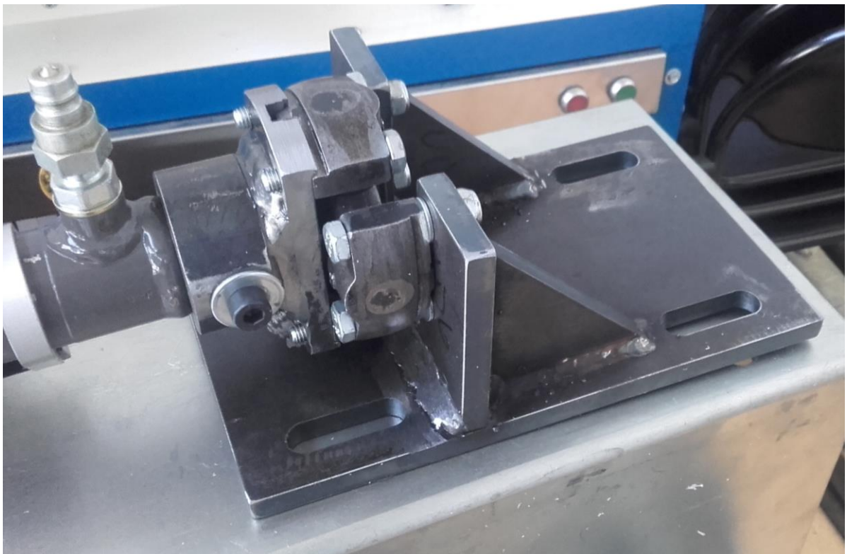
Figura 35: Platina base reforçada
