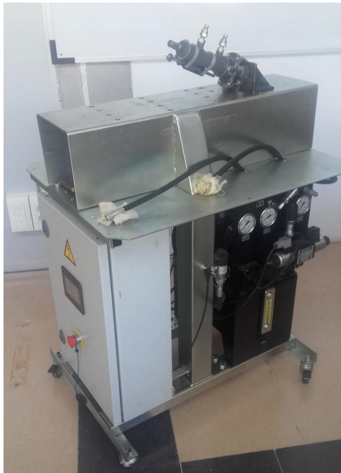
Figura 1: Màquina d'assaig a fatiga
