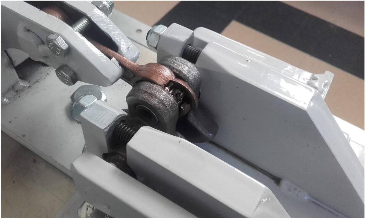
Figura 68: Trencament de la biela 1
