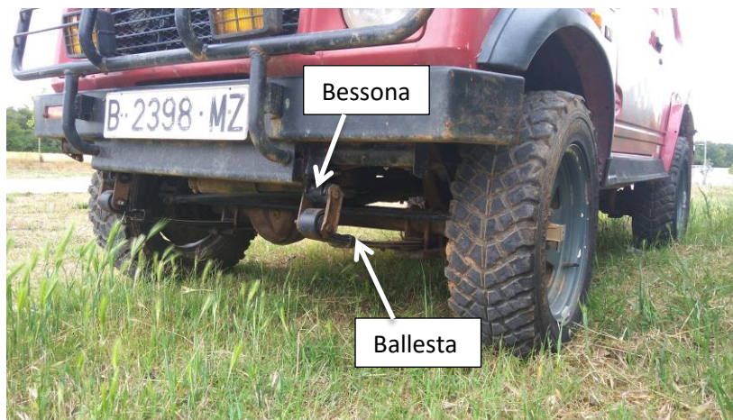
(Fig. 9) Sistema de ballestes d'un Suzuki Samurai vista per davant.
