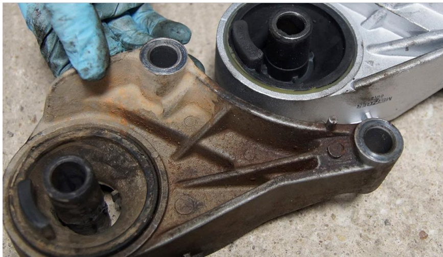
(Fig. 7) A la dreta un silentblock de motor en condicions i a l'esquerra el mateix desgatat. Aquest element de goma aïlla, en part, les vibracions del motor de la carrosseria.
