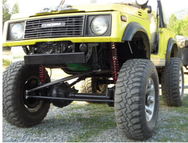
(Fig. 12) Suzuki Samurai modificat amb coil-overs i geometria de 3 links
