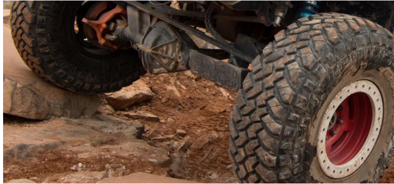
(Fig. 47) Es pot observar l'eix rígid davanter d'un tot terreny convencional preparat.
