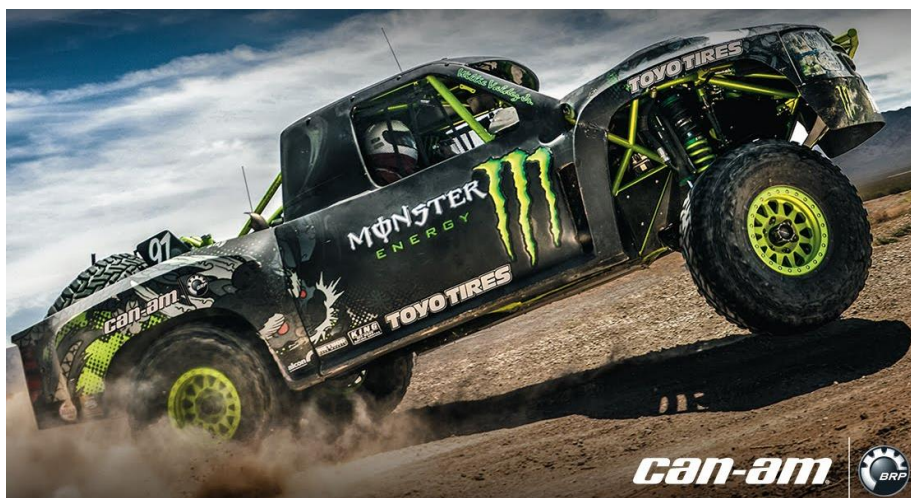
(Fig. 7) Tot terreny de la baja 1000 aixecant roda degut a la gran potència i al baix anti-squat.
