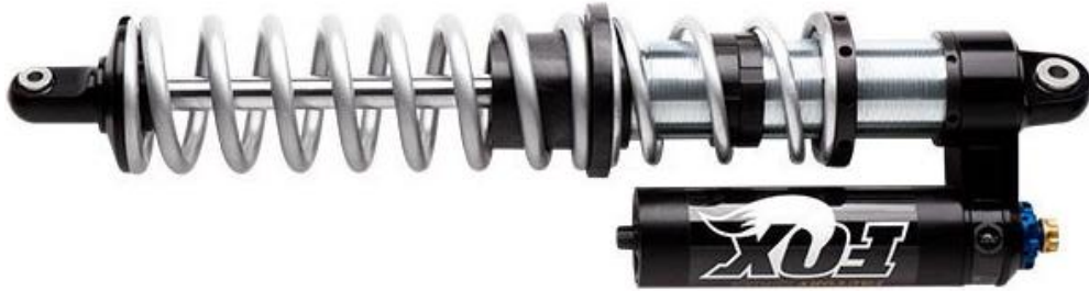
(Fig. 53) Fox coilover 2.5" x 10". (No és el model amb tecnologia Internal by-pass, però la variació és mínima). Es pot observar la configuració de doble molla i la capacitat de desplaçar la cara de suport de la molla a la dreta.
