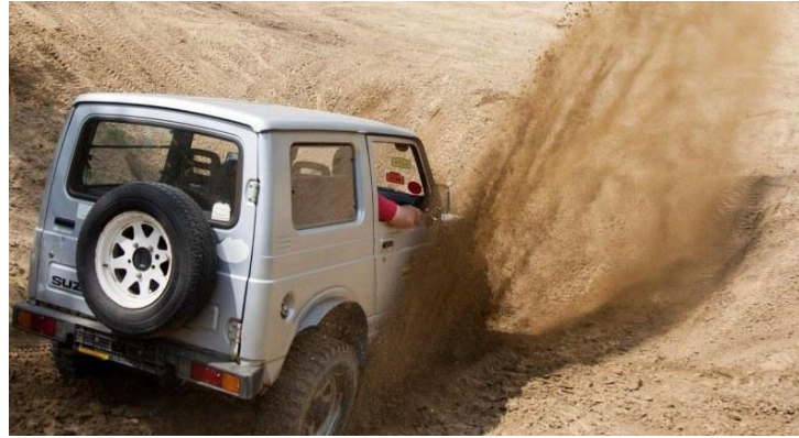
(Fig. 34) Suzuki intentant retrocedir on es veu que tot el parell es perd en una roda que no té suficient tracció al mateix temps que les altres no giren.
