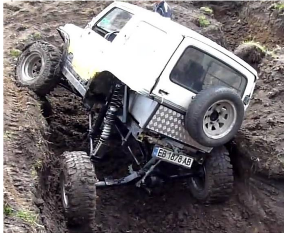
(Fig. 49) La força que rep la roda posterior dreta apropa l'esquerra al terra donant-li capacitat de tracció, en comptes que aquesta es quedi suspesa en l'aire.
