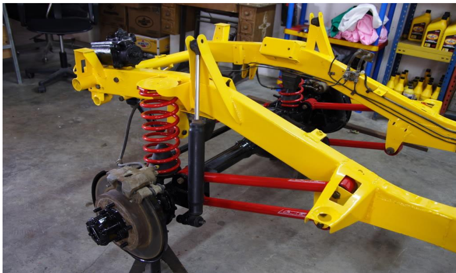
(Fig. 11) Xassís de Suzuki Samurai modificat amb sistema de molles helicoïdals i amortidors separats i geometria de 4 links
