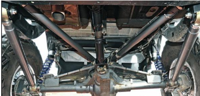
(Fig. 51) Sistema de suspensió de quatre links d'un tot terreny convencional.
