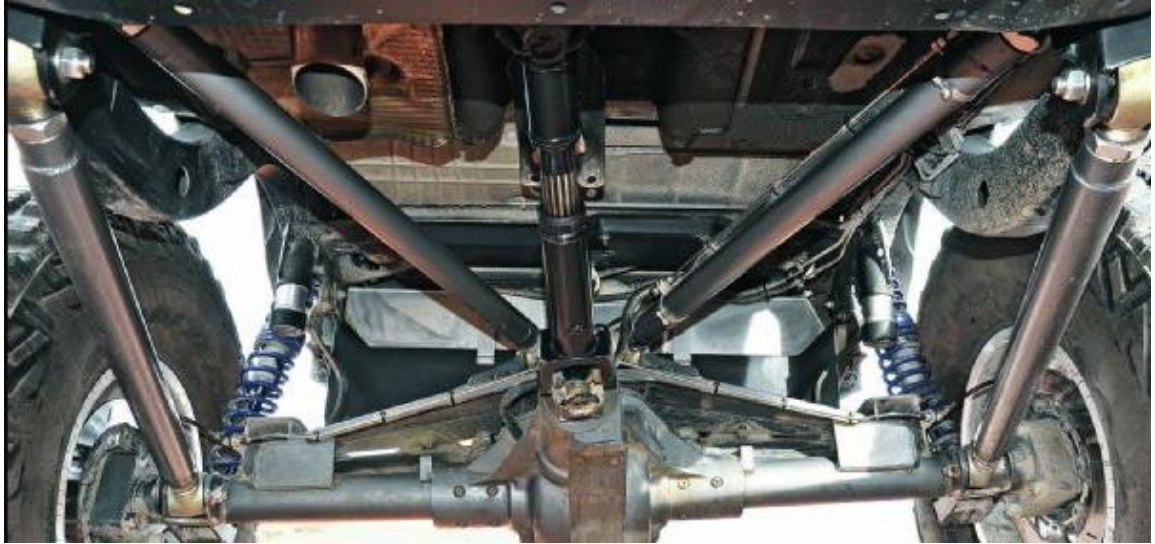
(Fig. 1) Sistema de suspensió de quatre links d'un tot terreny convencional.
