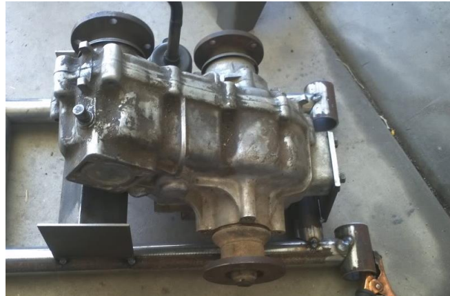
(Fig. 4) Caixa de transferència Suzuki Samurai. Amb posicions 2L, 4L, N i 4H sense diferencial central.
