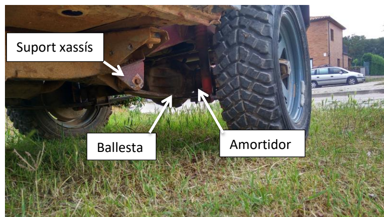
(Fig. 10) Sistema de ballestes d'un Suzuki Samurai vista per darrera.
