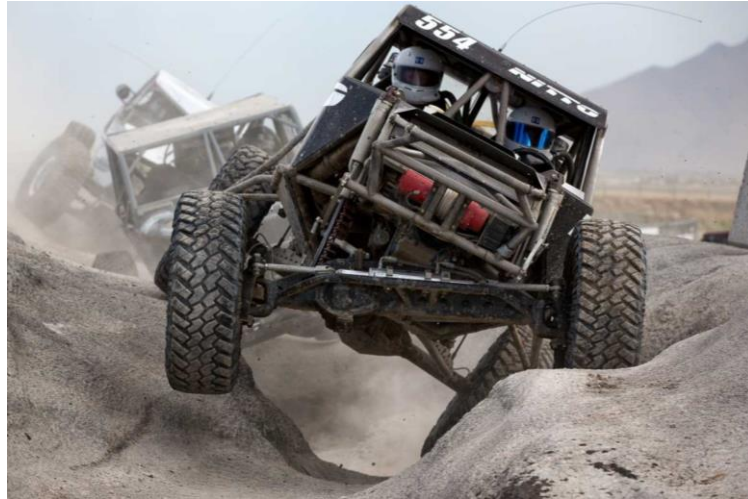
(Fig. 7) Vehicle de la Ultra4 superant una zona de creuament d'eixos. Es pot observar la inclinació entre eix i xassís.
