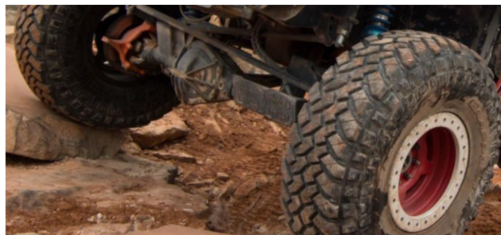
(Fig. 3) Es pot observar l'eix rígid davanter d'un tot terreny convencional preparat.
