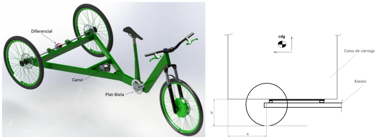
Figura 1: Disseny tricicle antic (esquerra) i esquema conceptual de la situació de la caixa sobre el xassís (dreta).
