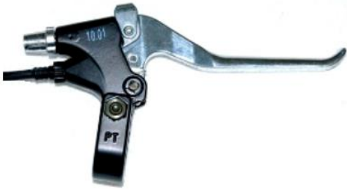
Figura 20: maneta de fre amb sensor PAR.
