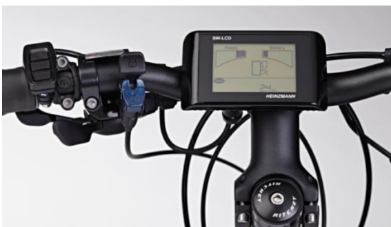
Figura 17: Display que mostra paràmetres del motor elèctric i del vehicle.
