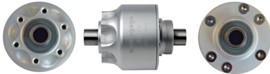
Figura 14: Diferencial SAMAGAGA DG72N instal·lat al vehicle. Representat en vista americana.
