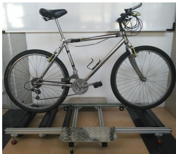
Figura 3. Banc de corrons construït
