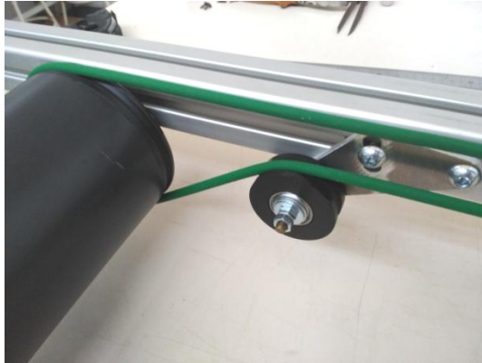
Figura 55. Detall pas de la corretja pel tensor
