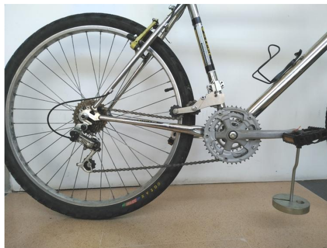
Figura 87. Muntatge pel calibratge del sensor
