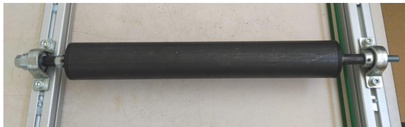
Figura 62. Corró d'inèrcia muntat al banc
