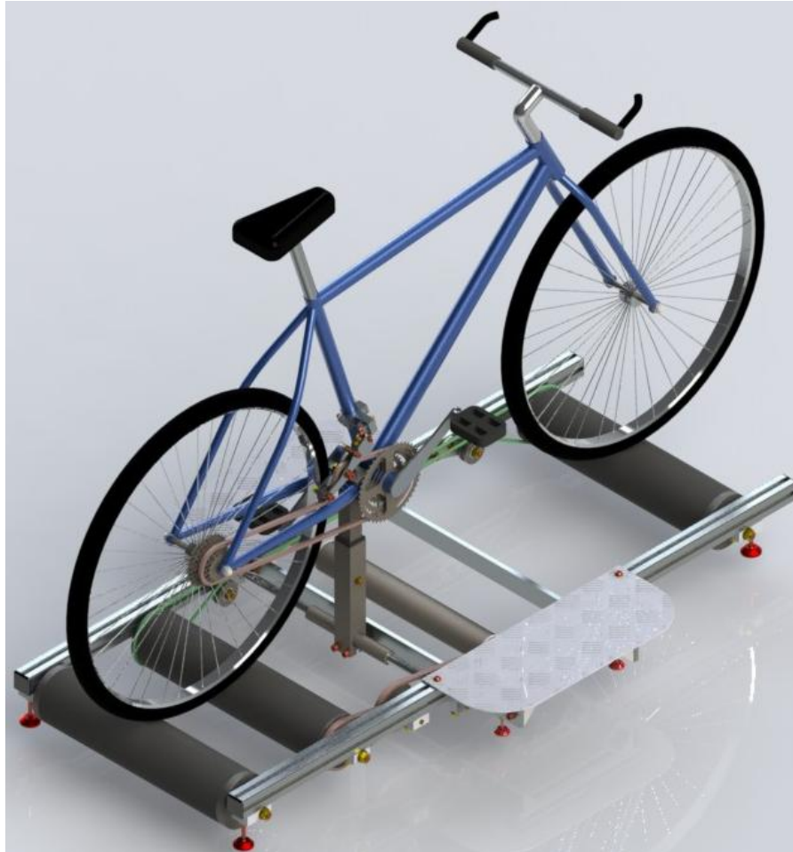
Figura 4. Banc de corrons dissenyat
