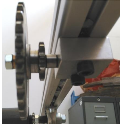
Figura 59. Muntatge pinions fase intermèdia
