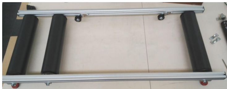
Figura 51. Banc de corròns + tensors
