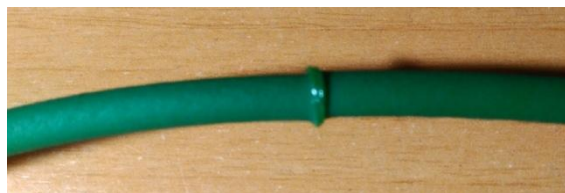
Figura 54. Resultat soldadura de la corretja
