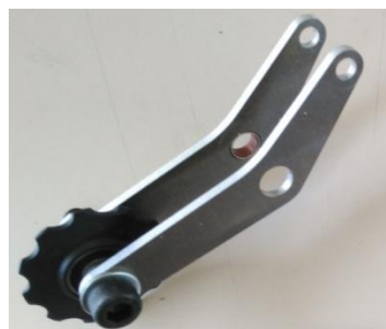
Figura 80. Muntatge suports segon pinyó
