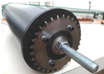
Figura 58. Pinyó Z30 muntat al corró de PVC
