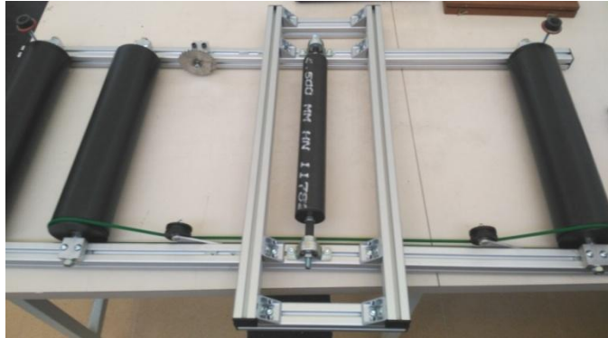
Figura 75. Muntatge plataforma al banc de corròns
