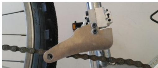
Figura 79. Muntatge suports primer pinyó
