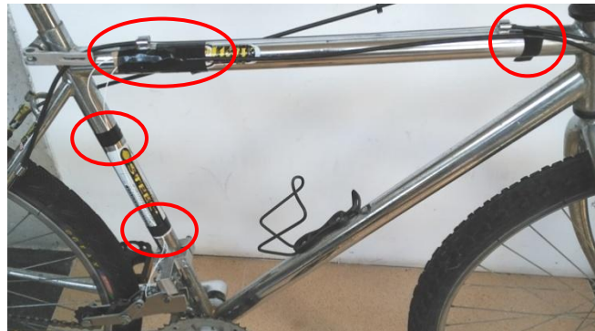
Figura 86. Fixació cablejat al xassís
