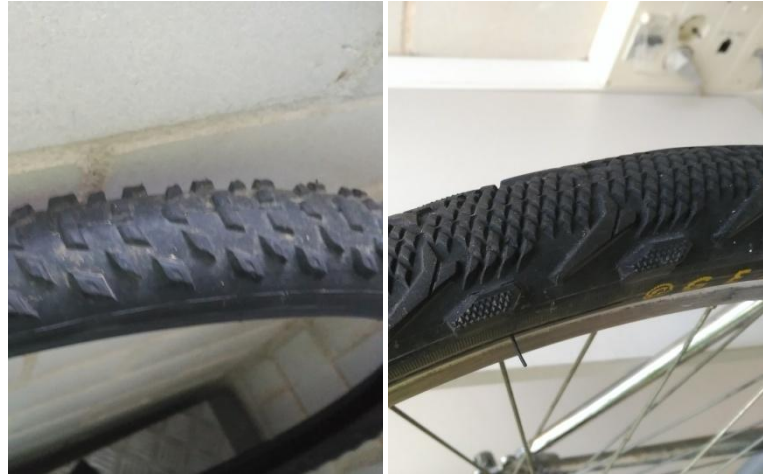
Figura 57. Comparativa entre el pneumàtic vell i el nou
