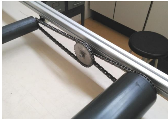
Figura 64. Muntatge cadena transmissió
