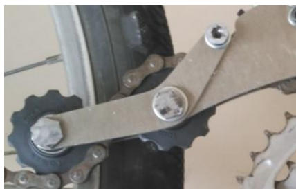
Figura 89. Rebaix dels caps dels cargols
