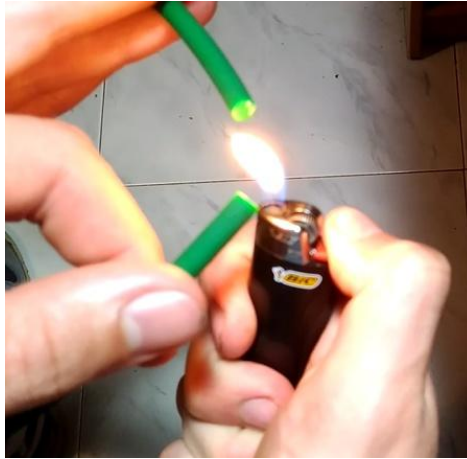
Figura 52. Aplicació de calor a la corretja
