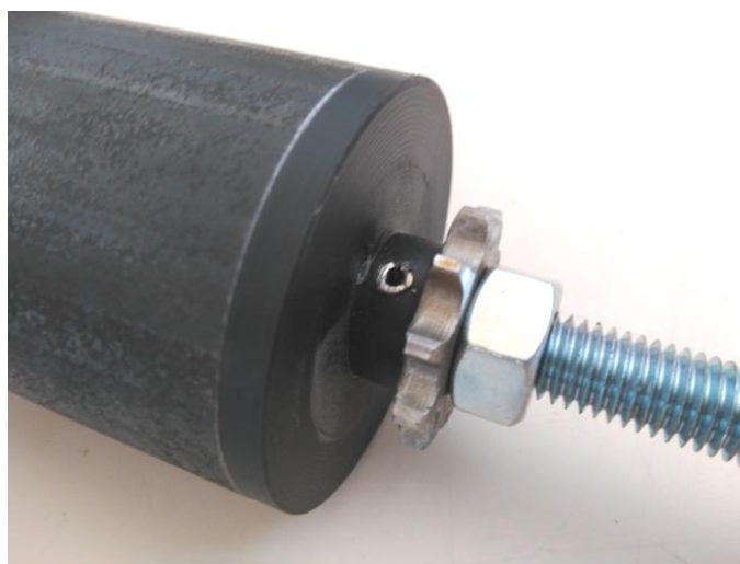
Figura 60. Muntatge clip elàstic d'acer
