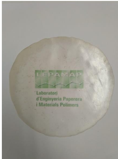
Figura 42: Film de TPS processat amb la premsa de plats calents
