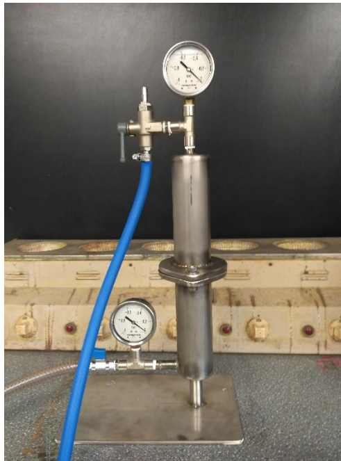
Figura 50: Aparell de permeabilitat a l'oxigen
