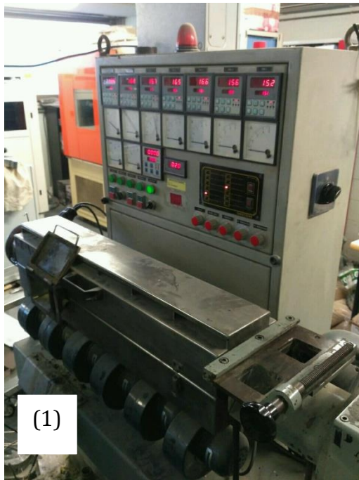
Figura 35: Extrusora emprada en la producció de films. (1): Imatge on s'observa la boca d'alimentació, la camisa, el sistema de refrigeració i de regulació de temperatures i velocitats i el desgasificador (2): Llavi de l'extrusora
