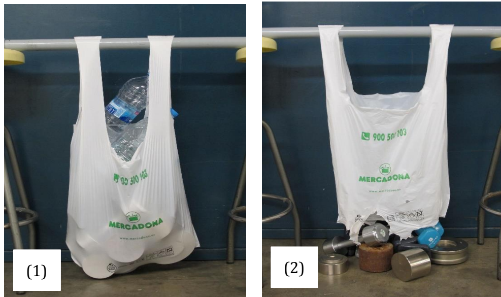
Figura 68: (1): Bossa carregada amb al moment de màxima carrega (2): Bossa quan ha reventat a causa de no suportar el pes acumulat
